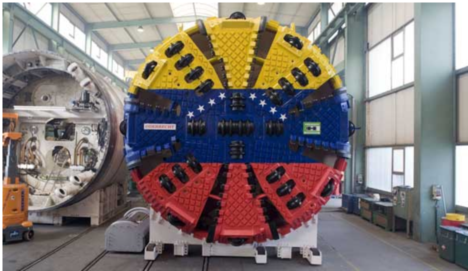
FIGURA 2.3.1.2.b.: Cabeza de corte con protección anti-abrasiva de la TBM-EPBs utilizada en el Proyecto Línea 5 del Metro de Caracas.
