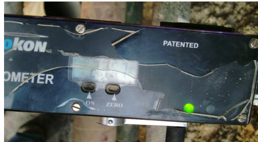
FIGURA 3.4.3.2.b.: Cinta extensométrica. Luz indicadora de lectura correcta.
