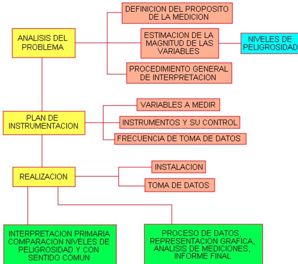
FIGURA 2.1.2.11.: Organigrama esquemático de actuaciones en una instrumentación.
