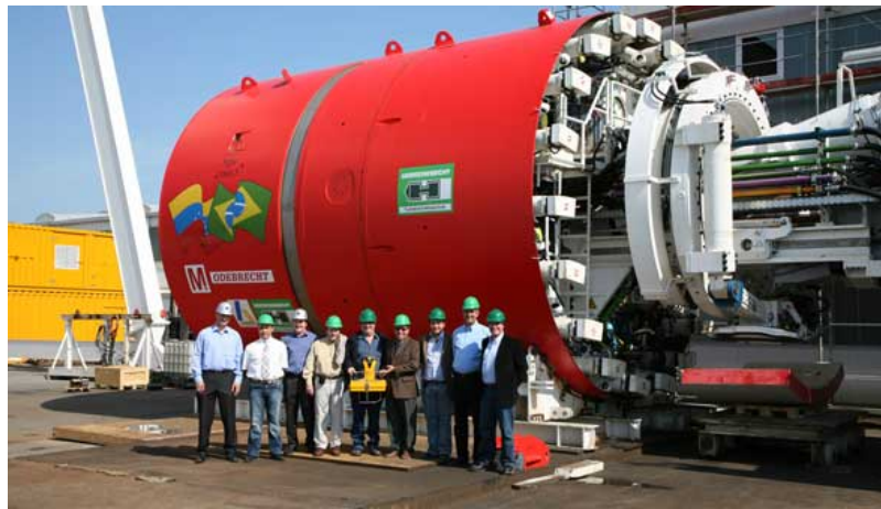
FIGURA 2.3.1.2.c.: TBM-EPBs Proyecto Línea 5 Metro de Caracas.
