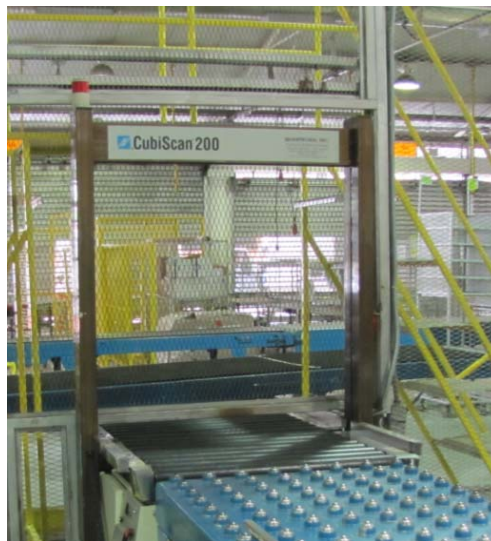
Figura 7: Fotografía de la máquina de Repesaje del área de Recepción de Camiones VAS
