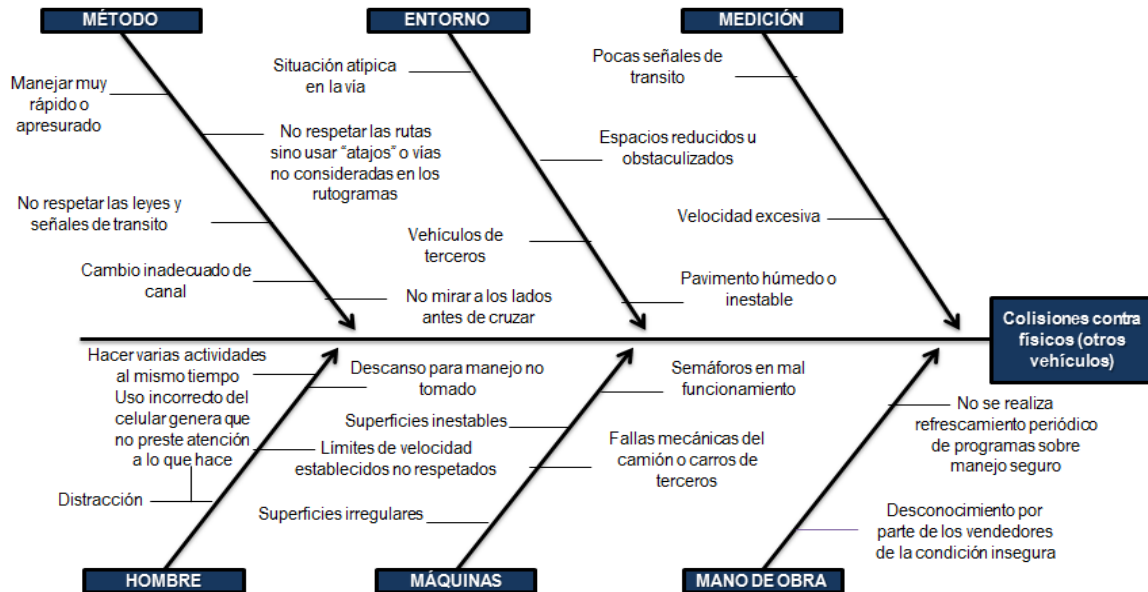
Figura 27: Diagrama causa-efecto del riesgo "Colisiones contra objetos físicos (otros vehículos)".
