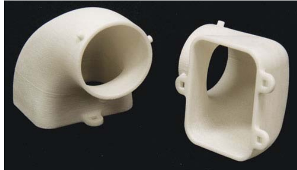
Figura 2.4 Pieza fabricada por SLS
