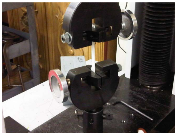
Figura 4.4 Estudio de tracción del ABS. Fuente: Estudios realizados en los laboratorios de la Universidad de Carolina del Norte (Elaboración Propia)
