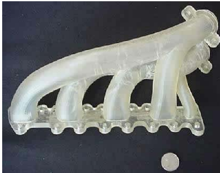
Figura 2.3 Pieza fabricada por deposición de hilo fundido
