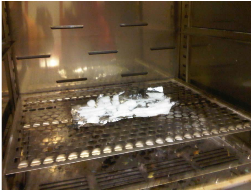
Figura 5.4 Muestras de Termoplástico de almidón dentro del Horno para extracción de humedad Fuente: Elaboración Propia
