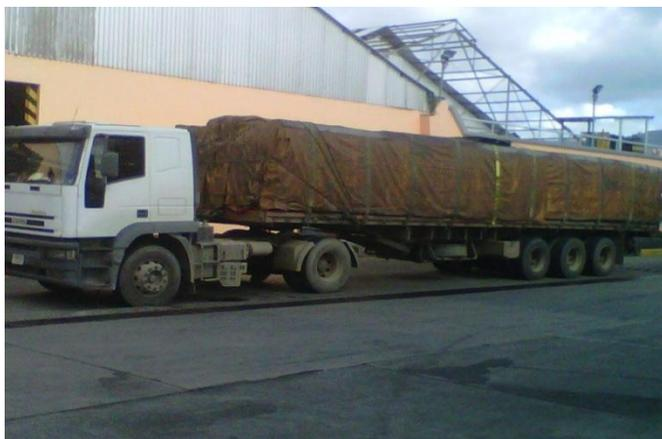
**FIGURA 5.** UNIDAD DE TRANSPORTE PRIMARIO TIPO BATEA
