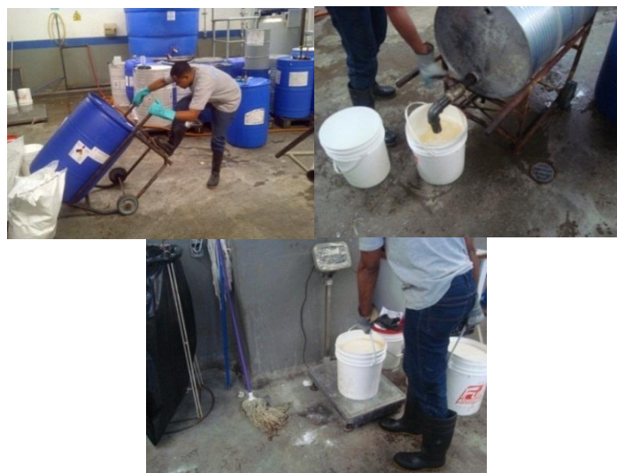
Figura 24. Proceso de volteo de tambores para extracción de materia prima
