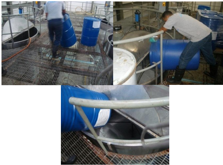
Figura 23. Proceso de Vertido de material prima en tambores a los tanques de mezclado
