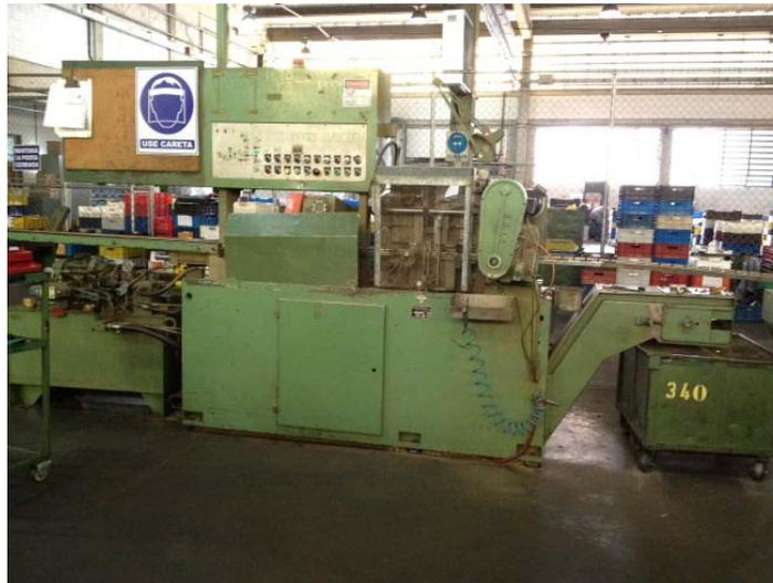
Figura.- 6 Máquina cortadora de cilindros.
