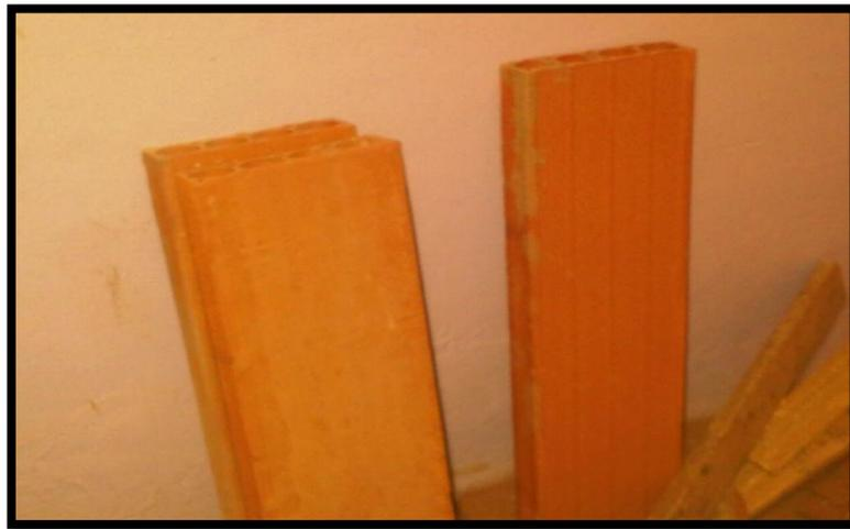
Ilustración N° 18: Tabelones empleados en losas de piso o cubierta.
