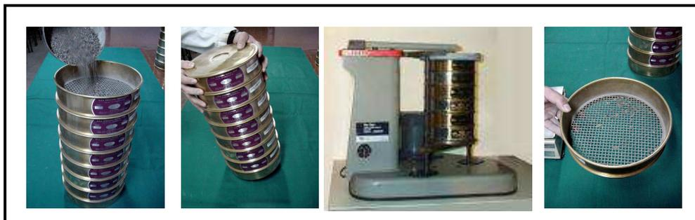
**Figura N° 10.- Análisis granulométrico**
