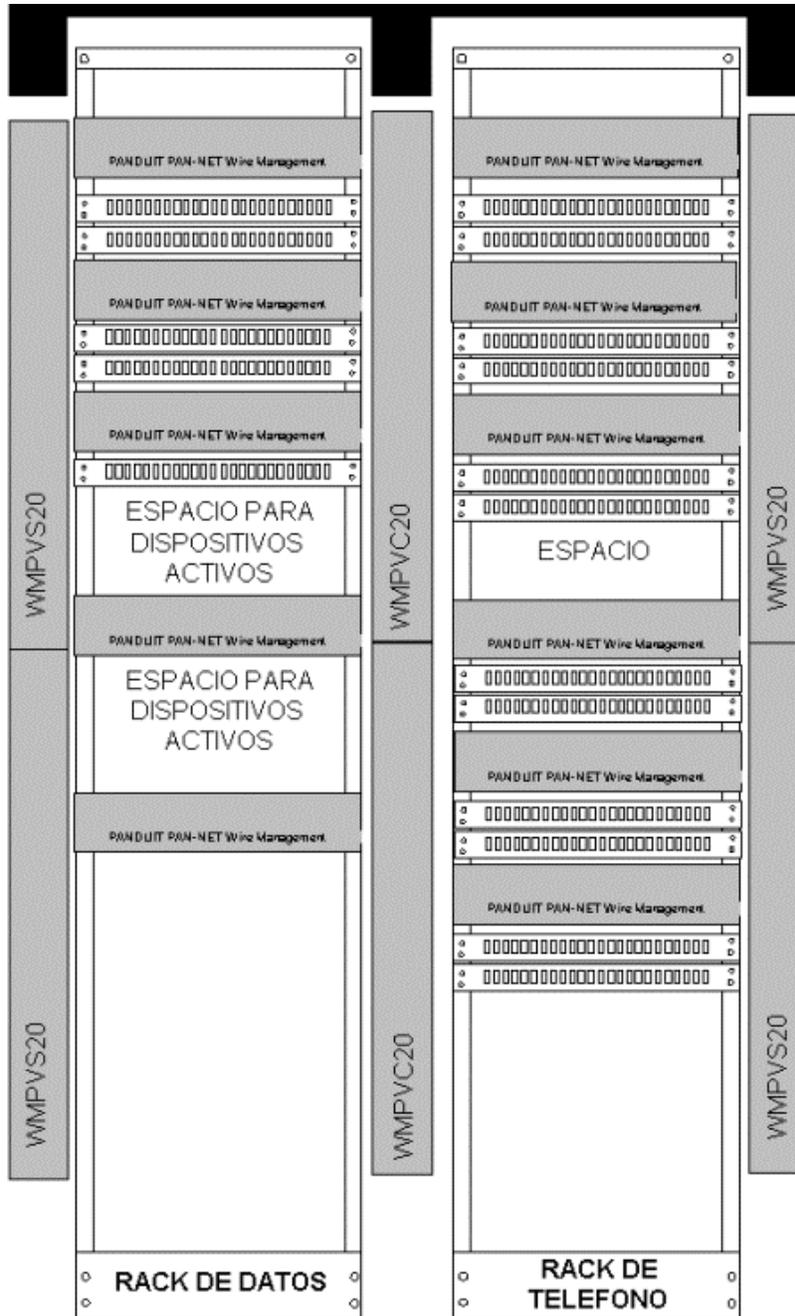
Figura 29. Configuración de Racks en CT
