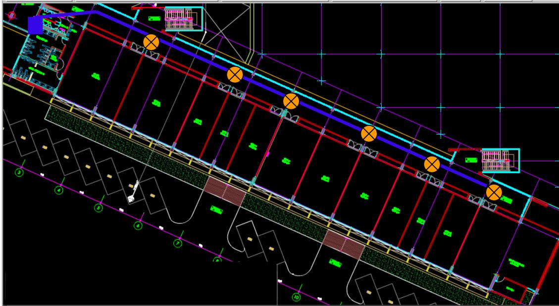
Figura 28. Recorrido Cableado Horizontal Pasillo Piso 2
