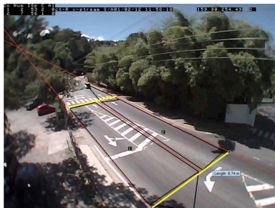
**Figura 36. Prueba de calibración de la cámara Collect-R x-stream.**
