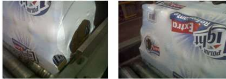
Figura 25. Cajas con huecos por exceso de calor (Fuente: Propia)
