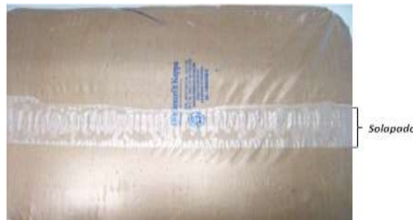
Figura 15. Solapado del Termoencogible (Fuente: Propia)
