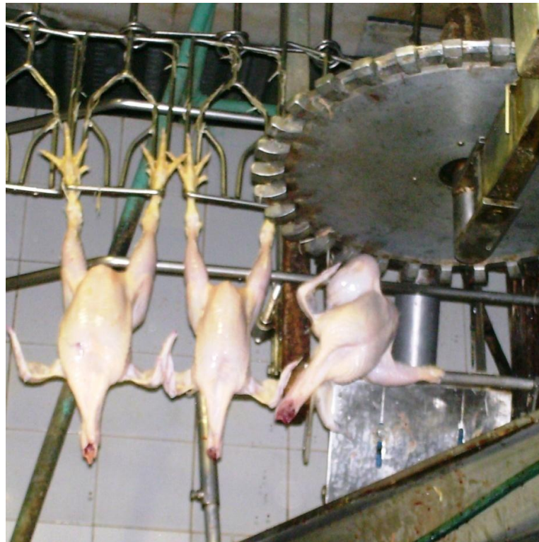
Figura 45.- Proceso de cortado de patas. Fuente: Cámara fotográfica.
