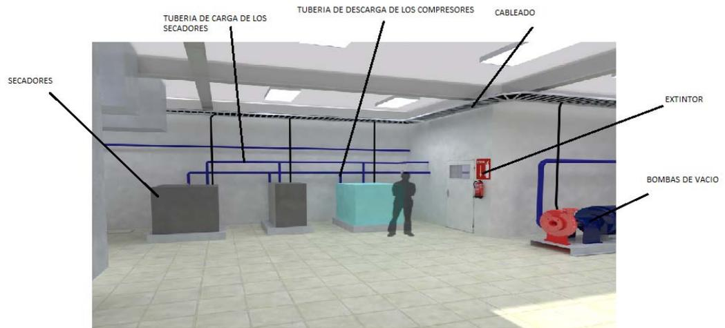
Figura # 14. Ubicación de los secadores de aire comprimido en la nueva sala de servicios
