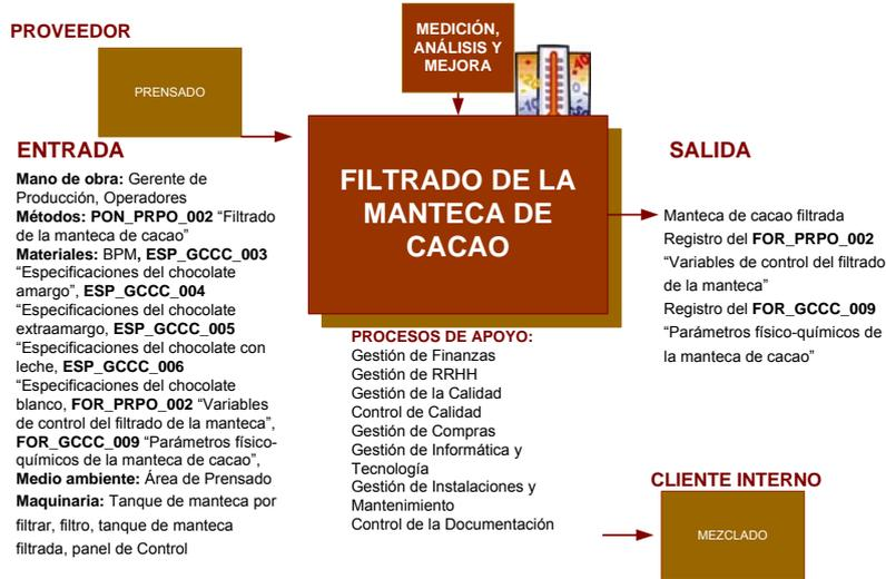
**Figura 18.** Proceso de filtrado de la manteca de cacao
