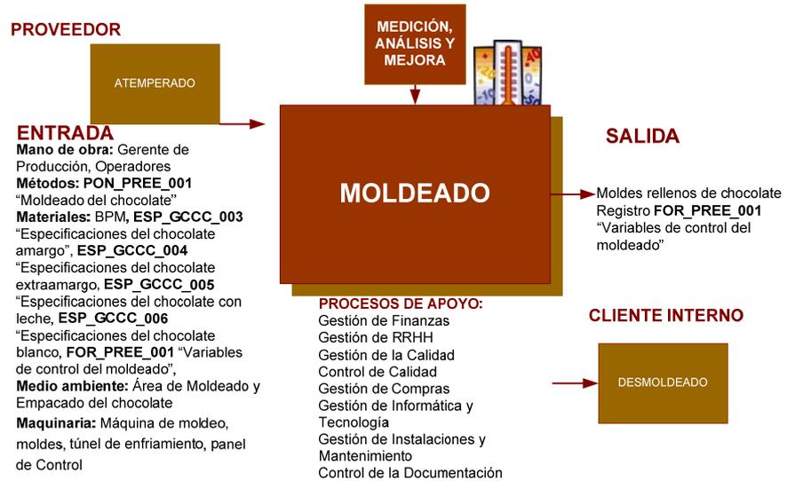
**Figura 23.** Proceso de moldeo
