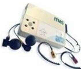
Un electrocardiógrafo es un aparato electrónico que capta y amplifica la actividad eléctrica del corazón a través de electrodos colocados en las 4 extremidades y en 6 posiciones precordiales. El registro de dicha actividad es el electrocardiograma.
