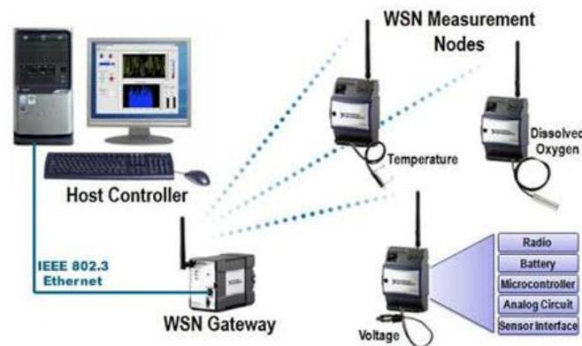
Figura 3. Arquitectura de Red WSN. Mota, Gateway y Estación Base.
