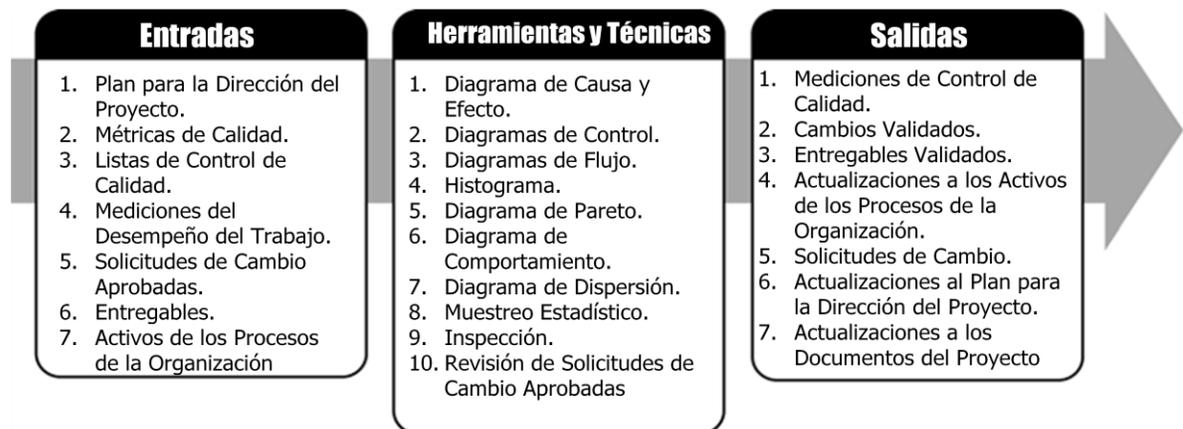
Figura 3 – Realizar el Control de Calidad: Entradas, Herramientas y Técnicas, Salidas
