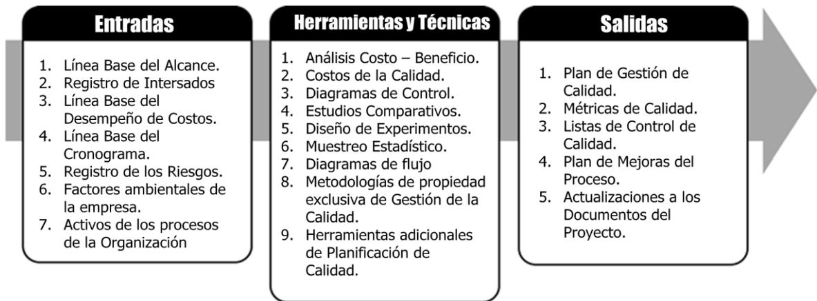
Figura 1 – Planificar la Calidad: Entradas, Herramientas y Técnicas, Salidas
