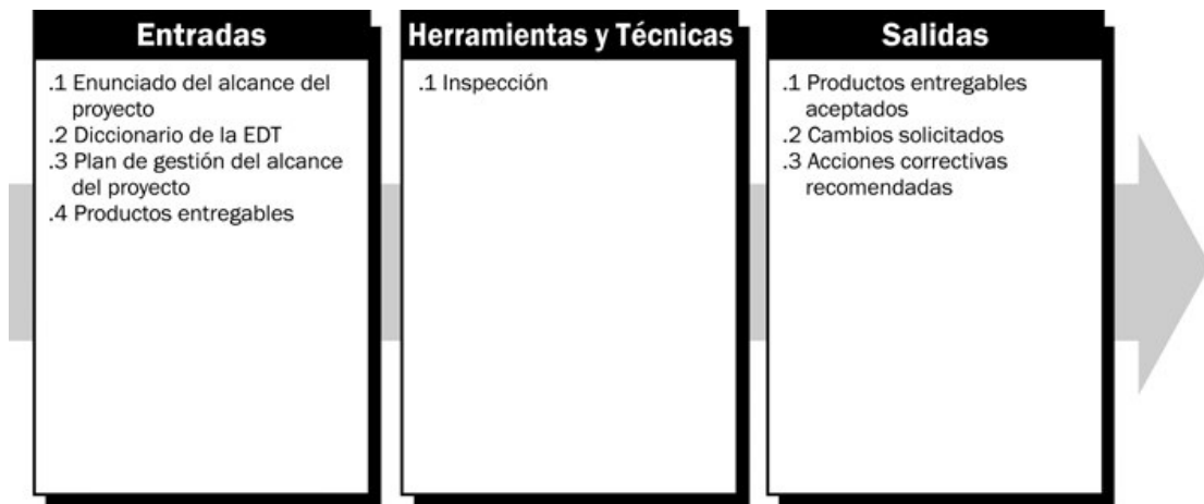
Figura No 4. Proceso de verificación de alcance.
