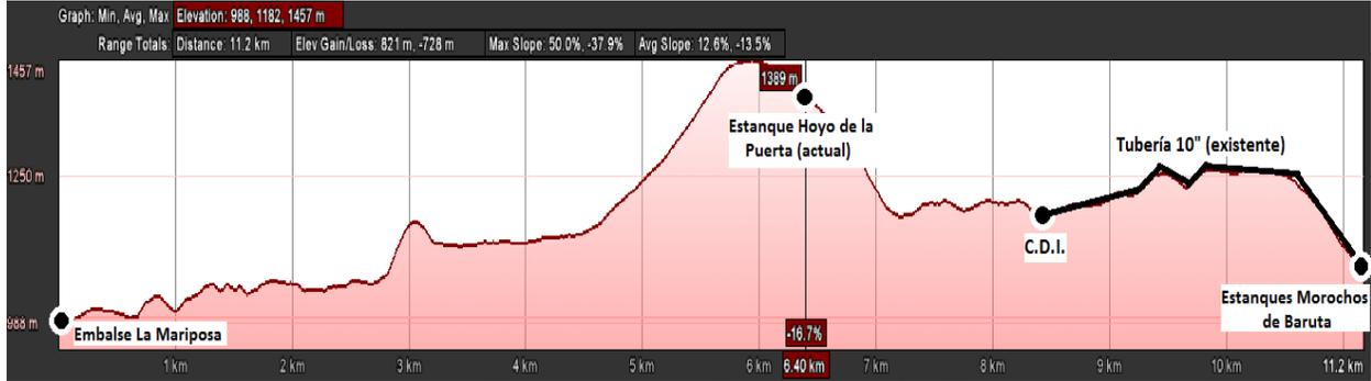
Figura 7. Perfil de Elevación: Fuente de Agua-Sistema A. (en línea recta)
