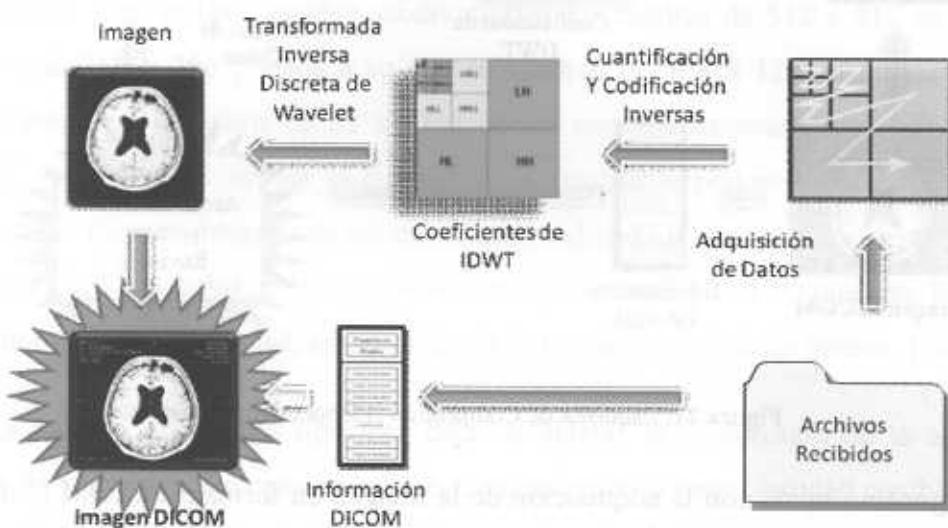
Figura 22. Esquema de Descompresión [Elaboración Propia]
