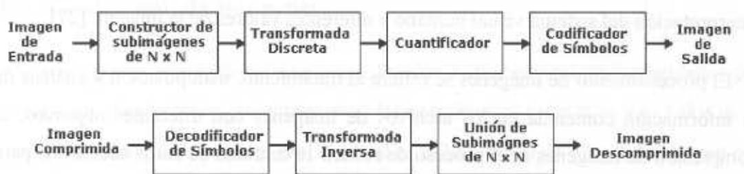
Figura 14. Esquema típico de Compresión de Imágenes [25]
