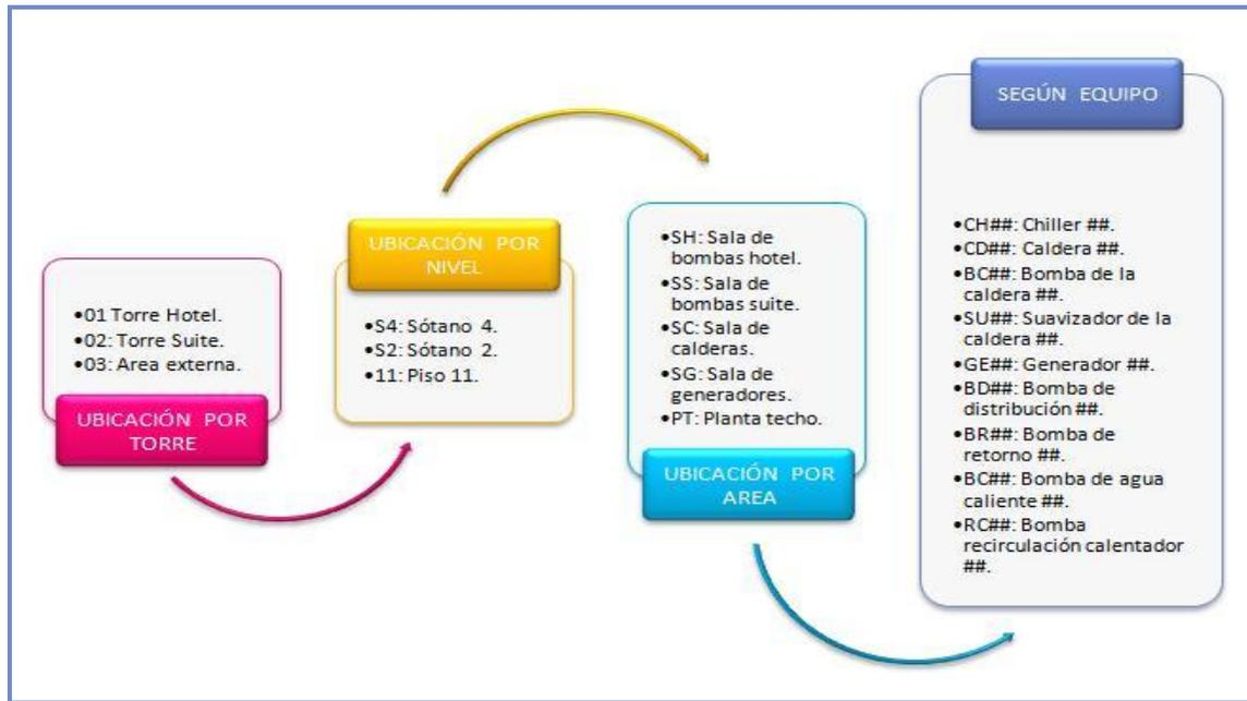
Figura 9. Sistema de codificación de equipos.
