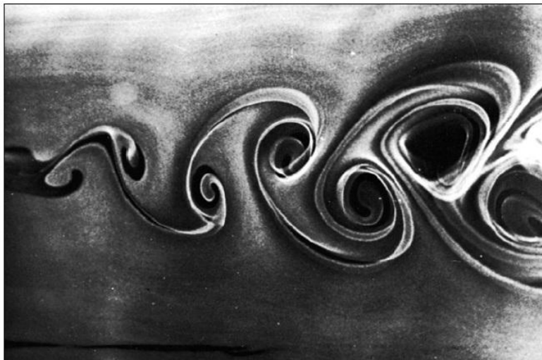
Figura 1 Generación de vórtices detrás de un cilindro. (Frank White)
