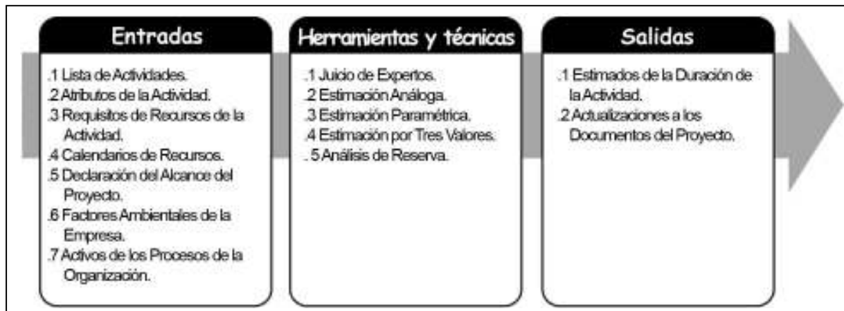
Figura 8. Estimar la Duración de las Actividades: Entradas, Herramientas y Técnicas, y Salidas (Guía del PMBOK®, 2008, p.124)
