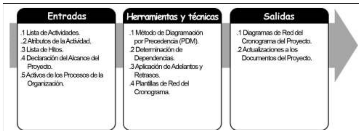
Figura 3. Secuenciar las Actividades: Entradas, Herramientas y Técnicas, y Salidas (Guía del PMBOK®, 2008, p.116)
