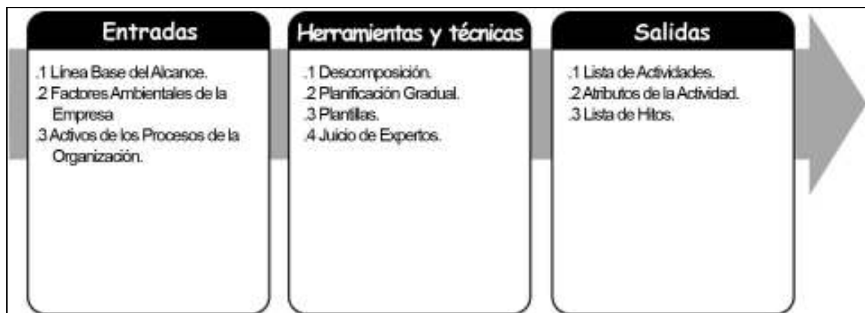
Figura 1. Definir las Actividades: Entradas, Herramientas y Técnicas, y Salidas (Guía del PMBOK®, 2008, p.114)
