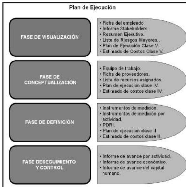
Figura 47. Estructura plan de ejecución.
