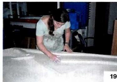
Durante su ejecución se efectúa el estudio de varios materiales para la construcción del modelo que deben cumplir los siguientes aspectos: impermeabilidad, moldeabilidad y bajo peso. Adoptando este patrón se usara una base de madera de unos 2 cm de espesor para la base del modelo cuyas dimensiones extremas son de 2,82 m por 1,60m; y el anime blanco de papelería para ir
