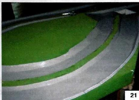
Para disminuir las rugosidades generadas por todos los materiales antes mencionados se colocan dos (2) capas de poliuretano transparente, que permiten una superficie más lisa además de garantizar la impermeabilidad de toda la superficie del canal.
