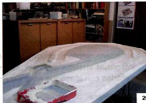
Finalmente, se colocarán tres (3) capas de Adesitop - 34 color gris para simular el color del concreto sobre toda la superficie del micro modelo. Este producto es usado en el área de plomería para crear una capa impermeable sobre las superficies donde es colocado.
