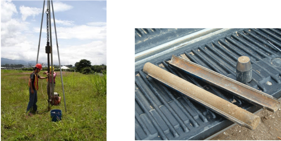
Foto N° 1: (a) Ensayo SPT, (b) Obtención de muestras con un muestreador de pared gruesa.
