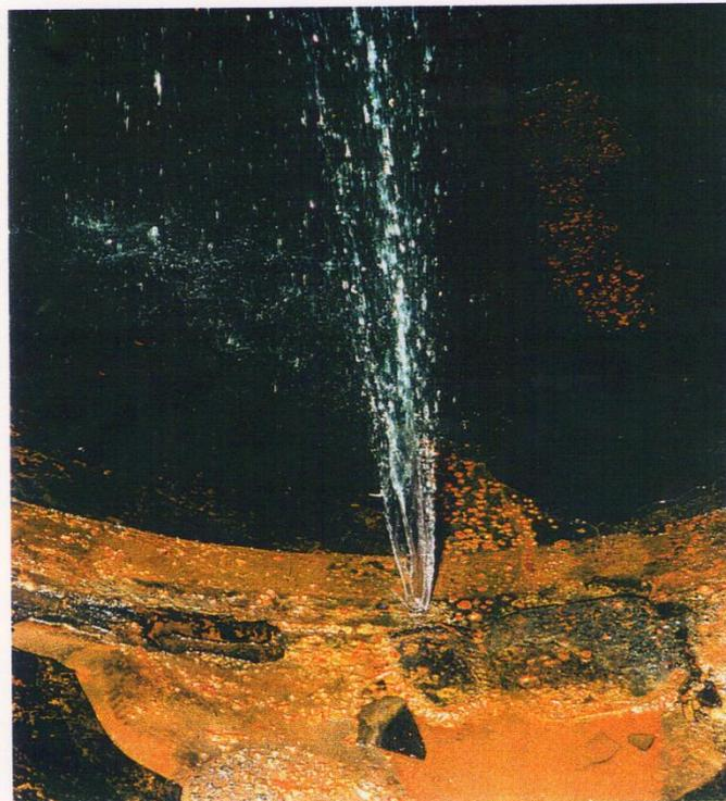
**FIGURA IV.1** Poro y Corrosión [Fuente: Trabajo Especial De Grado “ENCEMENTADO EN SITIO DE TUBERIA DE ACERO DE GRAN DIAMETRO. CASO TUBERIA  $\phi$  72 PULGADAS ALIMENTADOR NORTE CARACAS”]
