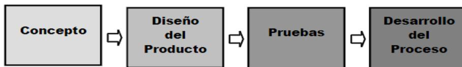
**Figura 11. Esquema descriptivo que propone la ingeniería secuencial.**
