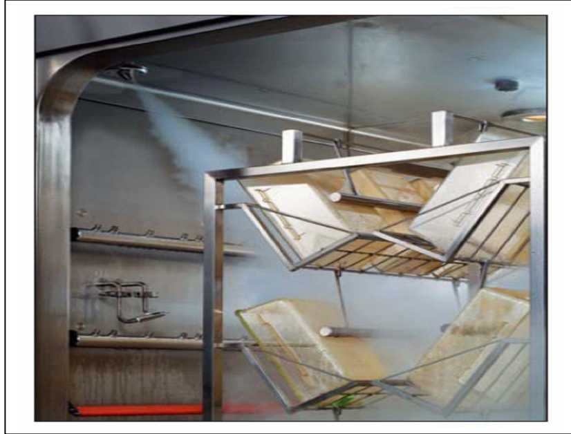
Figura No 23.- Máquina lavadora de jaulas. Fuente: Franco Mondini Tecniplast Italia. 2008
