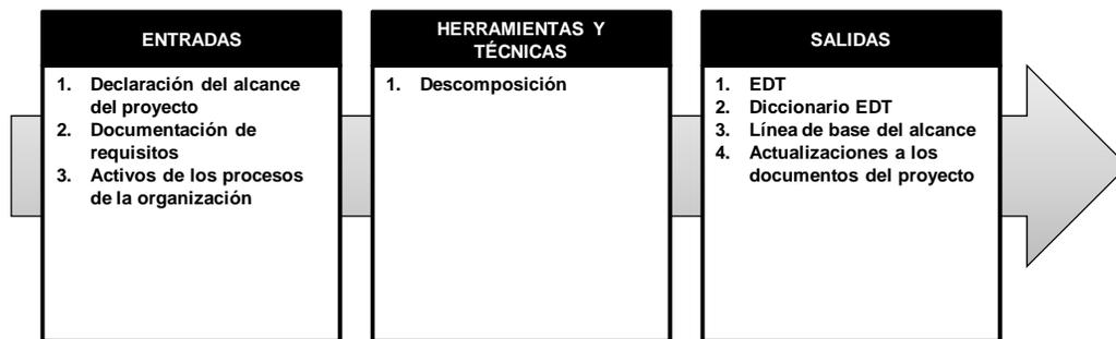
Figura 44. Crear la EDT: Entradas, Herramientas y Técnicas, y Salidas
