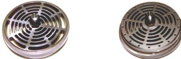
Figura 9. Válvulas Compresoras (Succión, Descarga)
