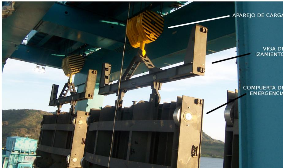
**Figura 4: Grúa 3x140 t. Componentes de un gancho.**
