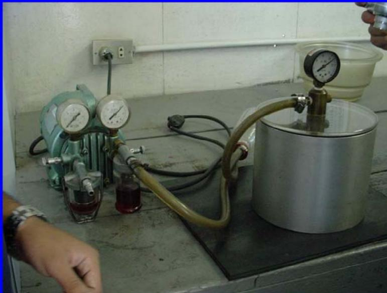
En esta fotografía se observa el equipo para el ensayo Rice: la bomba de vacío, el frasco, el dial con presión que se le coloca al frasco y el frasco con agua. El ensayo Rice no dura más de 10 minutos en realizarse y nos sirve para determinar la gravedad máxima de la mezcla sin compactar. Este ensayo se hace por triplicado y lo recomendable es que se realice en una mezcla que contenga el porcentaje promedio estimado de ligante.
