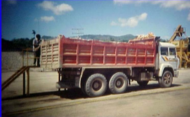
En la fotografía se observa el procedimiento de medición mediante una balanza de peso total. Como se puede ver, el vehículo debe estar completamente detenido a la hora del pesado
