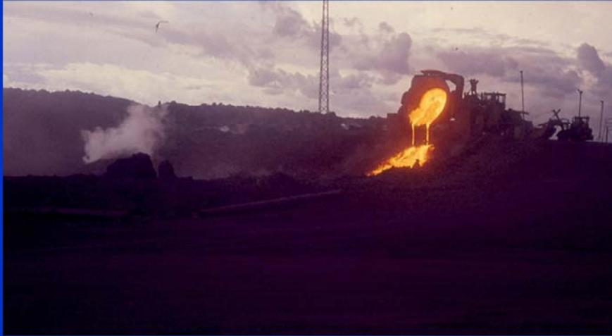
Los agregados siderúrgicos son agregados que no existen en la naturaleza y se obtienen como producto del procesamiento físico y químico de otros materiales. Algunos se obtienen del procesamiento de materiales fundidos, como escoria de acería, que luego es enfriado por agua. Su uso ha sido muy exitoso en la zona de Guayana, por ejemplo fue utilizado como parte de la capa de base granular en toda la vialidad del Segundo Puente sobre el Orinoco (Puente Orinoquia).
