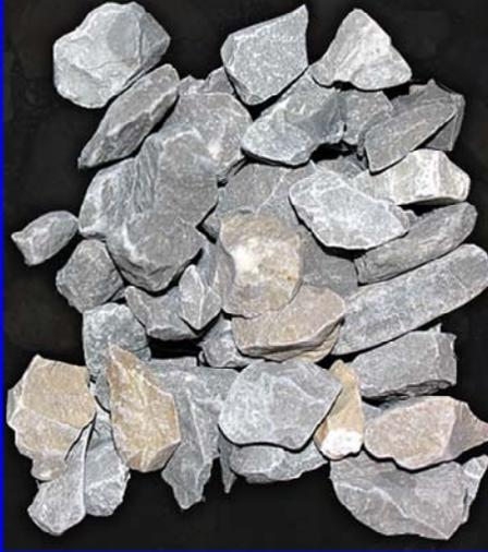
Son aquellos que han sido extraídos específicamente de canteras. Poseen las mismas características mecánicas de aquellos agregados extraídos de río pues son igualmente procesados
