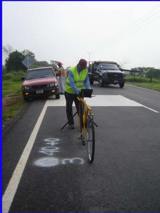
La evaluación de la rugosidad de un pavimento mediante la determinación del IRI es en la actualidad uno de los controles más efectivos relacionado con la calidad de terminación de un pavimento, que se refleja en seguridad, comodidad y costos de operación para los usuarios
