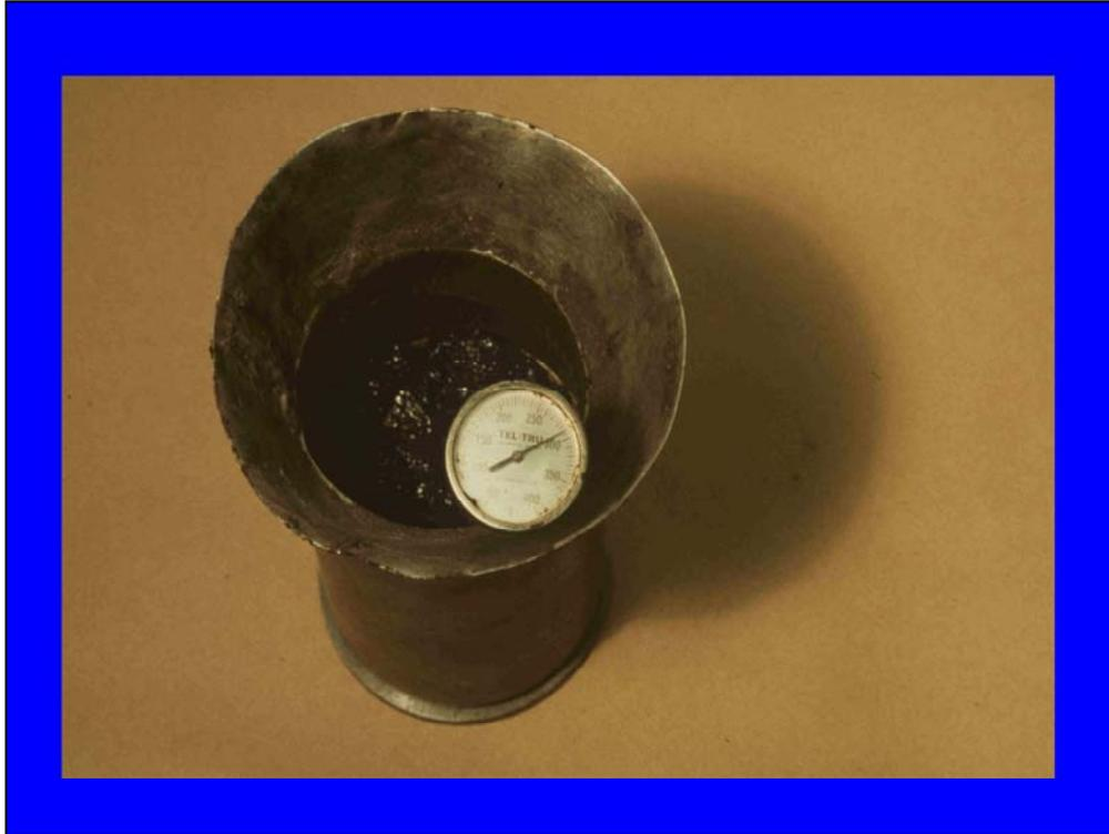
En esta fotografía se puede apreciar la mezcla ya vaciada en el molde. A continuación se le toma la temperatura para luego construir un gráfico de viscosidad-temperatura de la mezcla en si.
