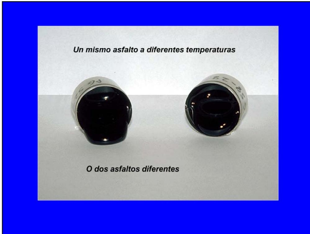
En esta fotografía se observan dos recipientes de los cuales se ha derramado un asfalto de distinta manera, sea porque es un mismo asfalto a diferentes temperaturas (recordemos que a mayor temperatura, menor es la viscosidad del asfalto) o porque son dos asfaltos distintos a la misma temperatura y sus componentes no son siempre iguales
