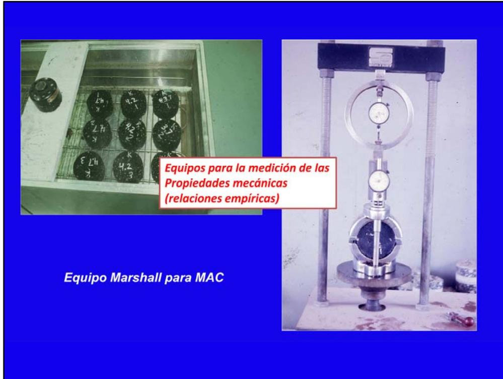
En estas fotografías se muestran los equipos para la medición de las propiedades mecánicas de una muestra de mezcla asfáltica. A la izquierda se observa el proceso en el cual se sumergen las briquetas fabricadas para la realización del Ensayo Marshall en un baño de temperatura constante a 60 °C y en la fotografía de la derecha se ilustra el proceso de ensayo de la briqueta en una mordaza, con un fluxómetro que indicará el valor de la estabilidad y deflexión de la briqueta.
