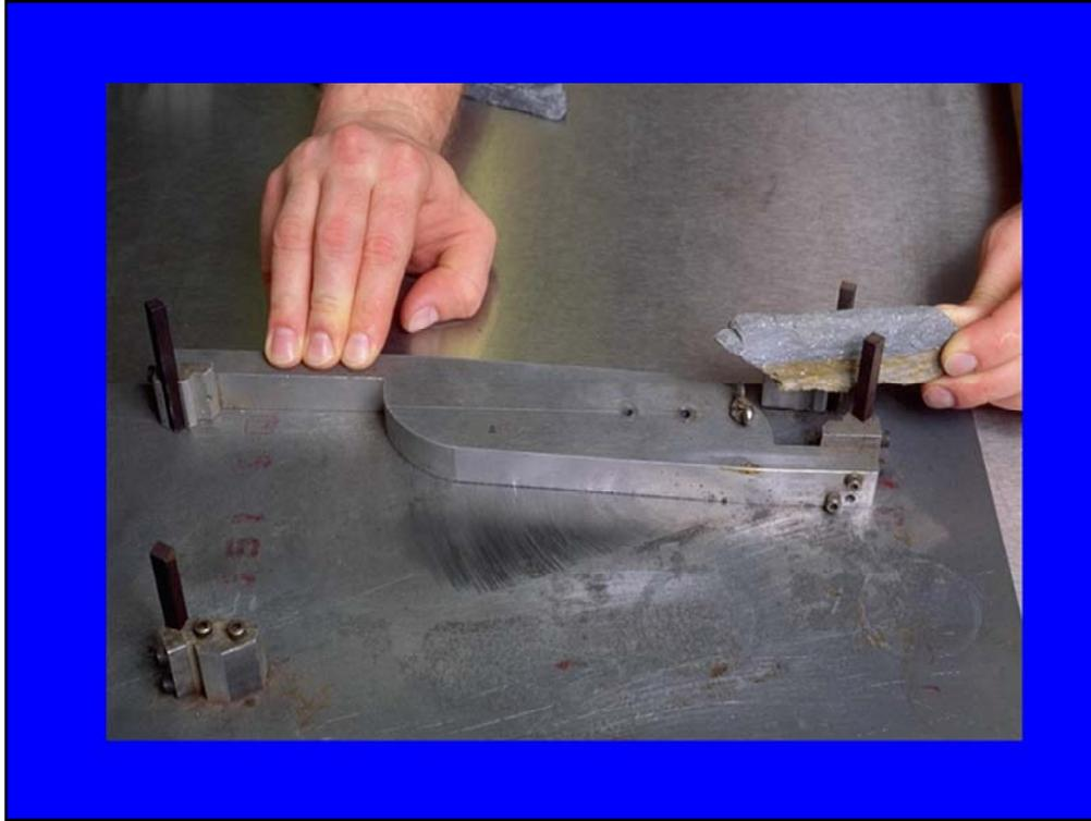
En la fotografía se muestra el proceso de medición de una partícula alargada.
