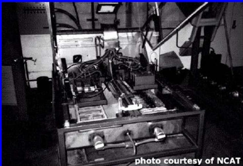
En esta fotografía se observa el equipo de ahuellamiento de la Universidad de Purdue. El ensayo se realiza normalmente con veinte mil pasadas o 20 mm de deformación con una carga de 375 libras sobre una rueda neumática que aplica una presión de 115 psi (793 kPa)
