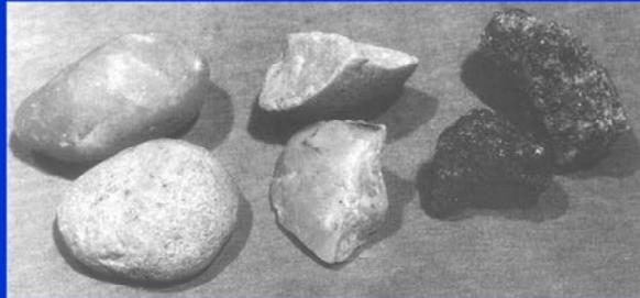
En esta figura se observan partículas de agregados con diferentes formas y texturas superficiales. Según la investigación de Fuller, los agregados fueron triturados de manera de demostrar el efecto de la textura de los granos en la densidad y resistencia CBR. Así se trituró la grava redondeada obteniendo como resultado la figura que se muestra aquí.
