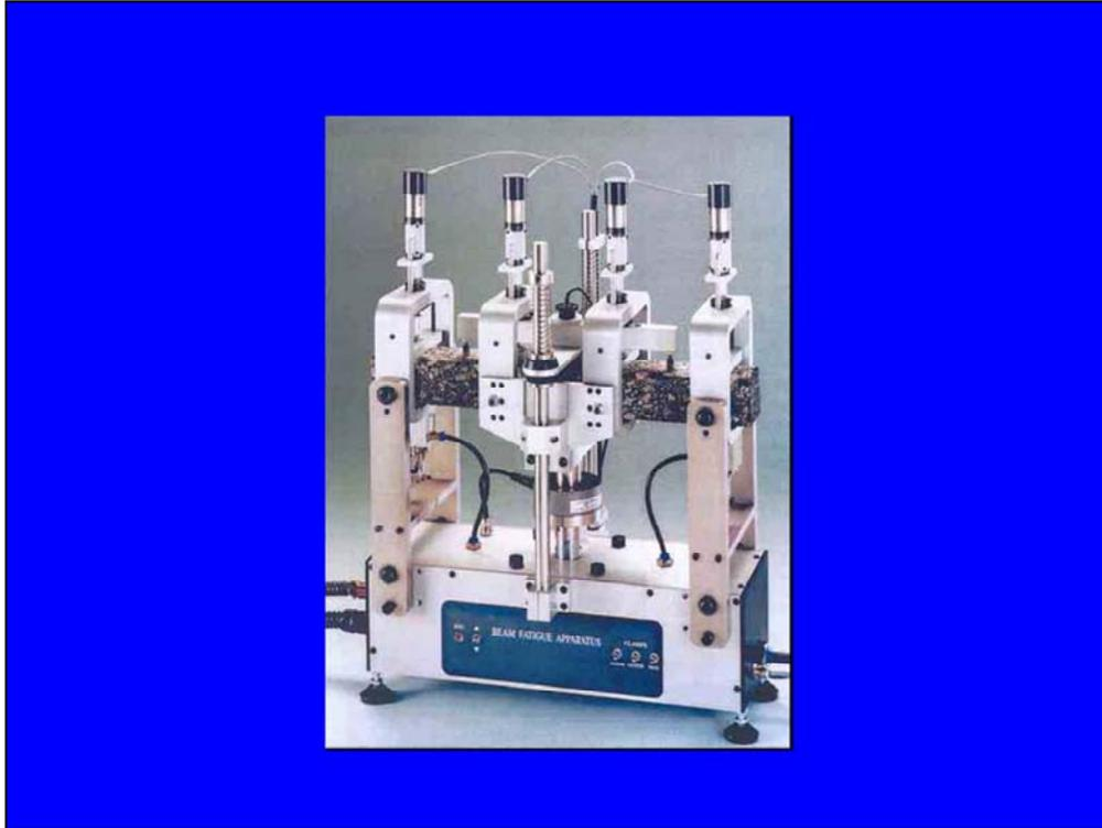
Se ensaya una viga prismática. Se somete a esfuerzo para medir durabilidad o resistencia
