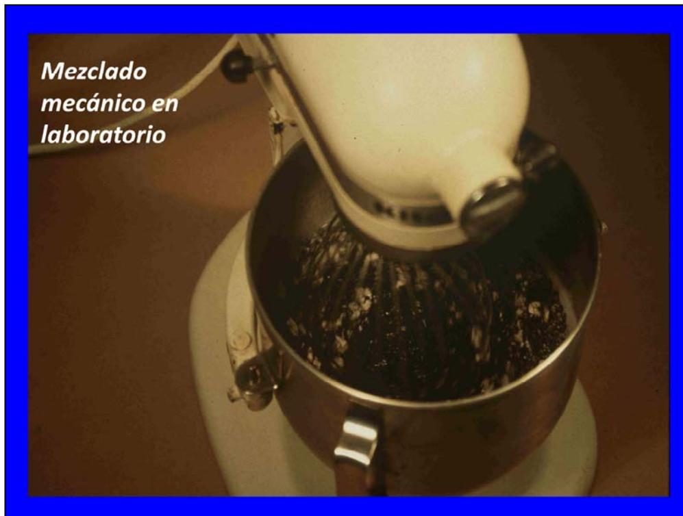
En esta fotografía se muestra como se va mezclando el agregado con el ligante de manera mecánica. Se puede observar que es un proceso simple y que incluso se utilizan instrumentos que no son especializados para esta función.
