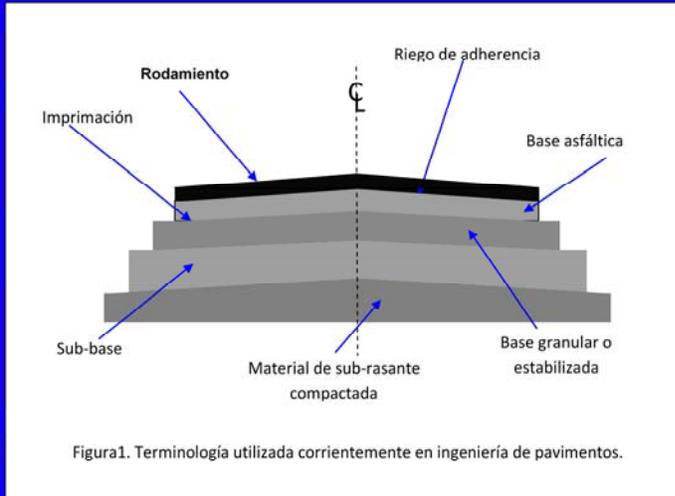
Figura1. Terminología utilizada corrientemente en ingeniería de pavimentos.
