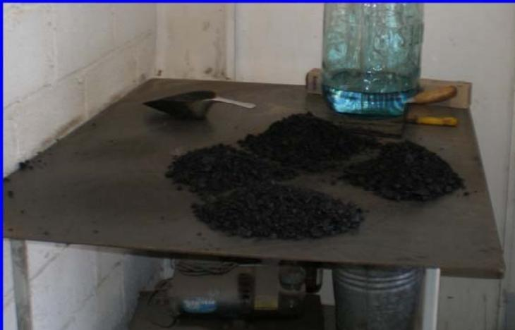
En esta fotografía se observa el cuarteo de una mezcla ya elaborada. La ASTM no obliga a hacer el cuarteo de alguna briqueta. Aquí se altera lo que se hace en campo, pues se trabaja con grandes masas
