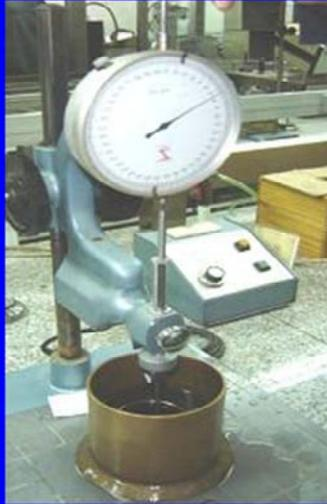
*Ensayo de Penetración (dmm)*
