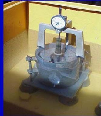
En las fotografías se muestra la etapa de inmersión del ensayo Proctor, que se realiza para determinar la humedad de saturación de una muestra del material de sub-rasante.
