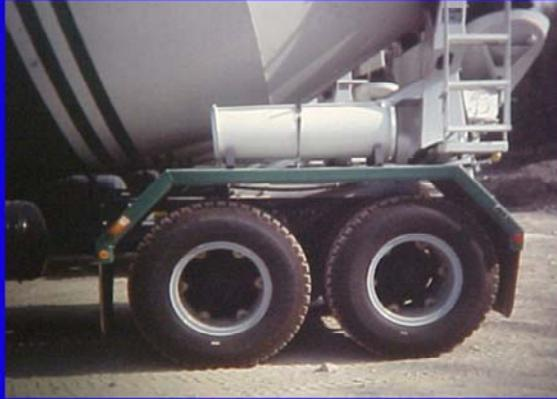
En la fotografía se muestra el detalle de un par de ejes sencillos que conforman un Eje Tándem
