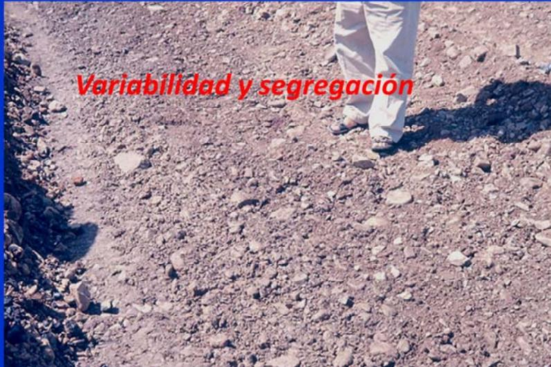
Como se observa en la fotografía, la gradación del granzón natural no es la que generalmente se persigue para la utilización del mismo como material para la sub-base. Se puede observar que hay partículas de tamaño exagerado que no son útiles a la hora de la construcción del pavimento. Por esta razón se recomienda hacer una combinación de agregados de modo de seleccionar los tamaños más convenientes.
