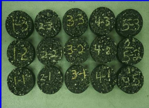
Se recomienda que la altura de cada briqueta sea lo mas cercano a las 2.5 pulgadas, para que el "factor de corrección" por volumen esté entre 0.96 y 1.04, y así las densidades de briquetas serán similares, ante la energía de compactación constante del martillo Marshall.
