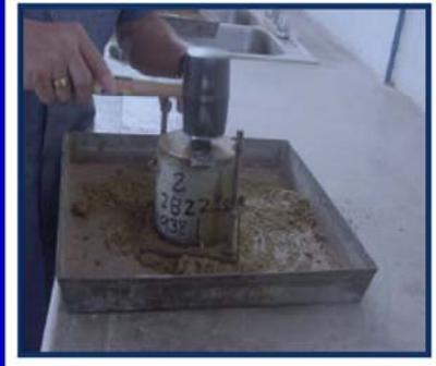
En la fotografía se observa el proceso de compactación de la muestra. Se hace una clasificación para la ejecución del ensayo proctor, dependiendo si se realiza para la capa de sub-rasante o la de base y sub-base que corresponden a agregados más gruesos. Se debe recordar que la diferencia entre el ensayo Proctor Estándar y el Ensayo Proctor Modificado radica en la energía de compactación utilizada.
