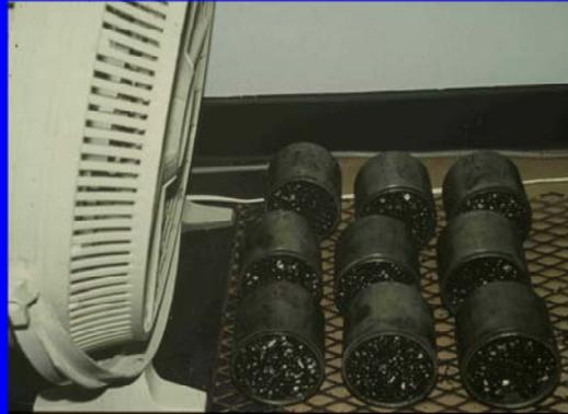
Para el método Marshall se prueba mas adelante que las briquetas sean enfriadas con agua. La justificación anterior sostenía que si se moja la briqueta no se pueden cerrar los vacios y no poseería la durabilidad requerida. Lo recomendado es que se enfríen naturalmente sin la ayuda de un agente externo, pero por la posible prisa del ensayo se recurren a otros métodos como el enfriamiento con ventilador o aire acondicionado (aunque siguen no siendo lo ideal)
