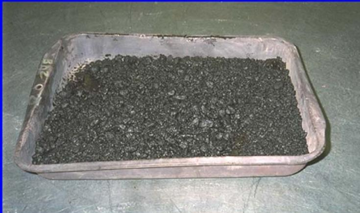
*Se realiza por triplicado sobre muestras de la mezcla sin compactar, para la mezcla con el contenido de ligante que corresponda al "Punto de asfalto" medio del rango de diseño.*
