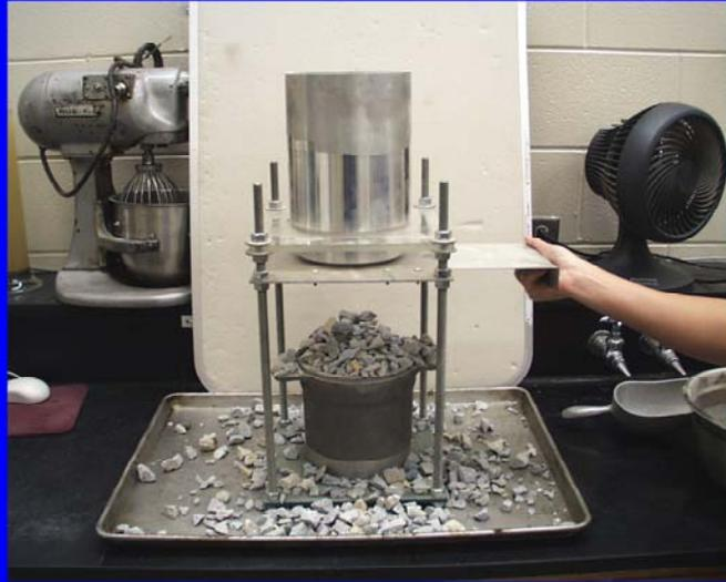
El primer paso en este ensayo es preparar la muestra de agregado que luego es vertida en la cámara superior. La compuerta inferior es rápidamente removida y el agregado fluye libremente en la unidad de pesado en la parte de abajo
