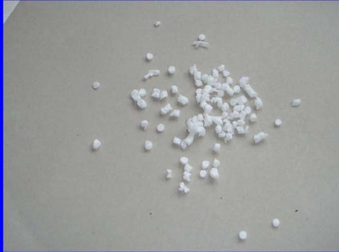
SBS:(estireno-butadieno-estireno) o caucho termoplástico. Es un polímero elástico utilizado para el mejoramiento de mezclas asfálticas de manera de incrementar la resistencia al deslizamiento
