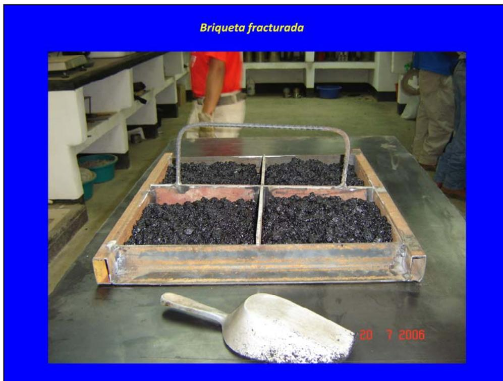
En esta fotografía podemos observar una briqueta fracturada para ser ensayada por cuestiones de control de calidad. Estos procesos no están contemplados en el método de la ASTM
