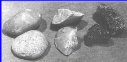
En esta lámina se muestra primero una figura en la que se observa una granulometría producto de una combinación de agregados para poder satisfacer las condiciones y límites que establecen las Normas COVENIN e INVEAS. En la fotografía inferior se muestran distintos tipos de agregados. El de la izquierda corresponde a un agregado redondeado mientras los otros dos son el producto del procesamiento de los primeros mencionados
