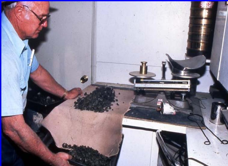
En esta fotografía se observa la preparación de la mezcla asfáltica. En este paso se pesan los agregados que ya han sido mezclados con el cemento asfáltico de modo de obtener los valores más exactos posibles.
