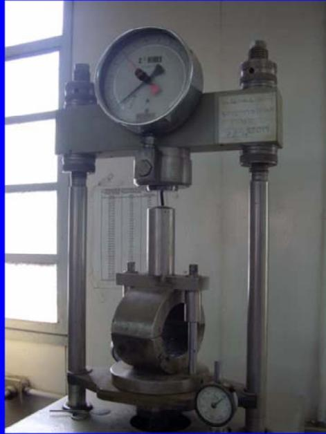
El Método Marshall para el diseño de mezclas asfálticas en caliente
