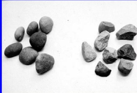
Esta fotografía ilustra partículas de grava de río de forma redondeada (lado izquierdo) y el cambio que se produce al triturarlas (lado derecho). En el ensayo se toma una muestra de material retenido en el tamiz #4 y se agrupan las partículas con forma angular (proveniente de la trituración) y separadamente las de forma redondeada. El peso de la fracción que contiene las partículas trituradas entre el peso total de la muestra (redondeadas + trituradas) se define como angularidad de los gruesos.
