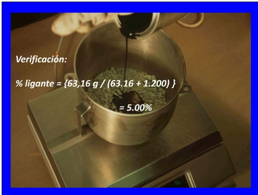
En esta lámina se comprueba que el cálculo de contenido de ligante sea correcto. Se toma el valor calculado entre la suma del peso del agregado más el del ligante calculado y debería arrojar el resultado obtenido en la lámina anterior
