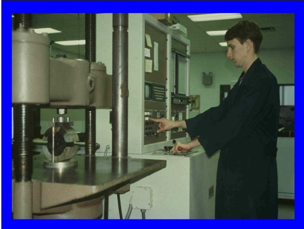
La fotografía muestra al operador ensayando la briqueta a compresión
