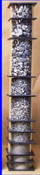
La "estructura granulométrica" o simplemente "granulometría" se define como la distribución de tamaños del agregado que se empleará para "formar" una mezcla asfáltica.
