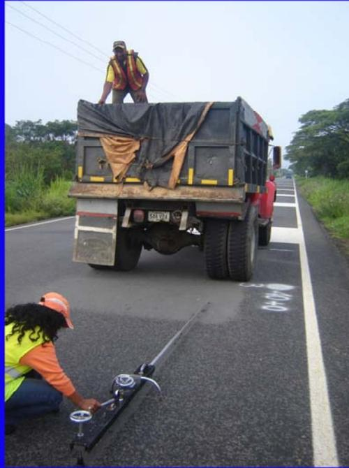
Para la medición de deflexiones se utiliza una viga Benkelman. El procedimiento para realizar este procedimiento debe ser bastante preciso: consta de un camión, ruedas gemelas con una distancia mínima entre ellas de 55 mm (recomendable 60 mm) y una presión de inflado determinada.
