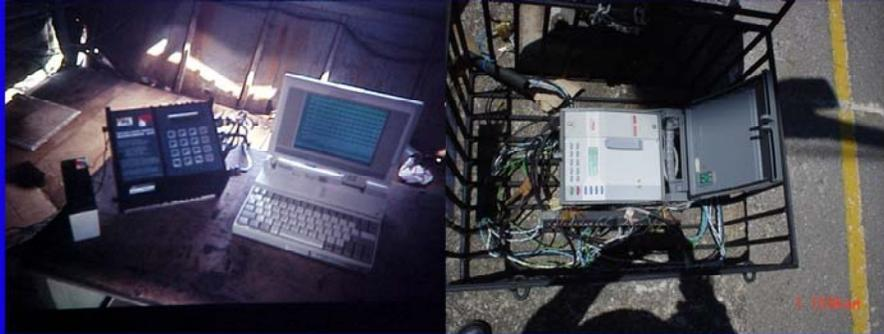
En este esquema se muestra el procedimiento de recolección de la data del pesaje por medio de un sensor piezoeléctrico. El sensor transmite los datos al equipo al que esta conectado y desde allí se pasa la información a una computadora portátil donde éstos puedan ser analizados
