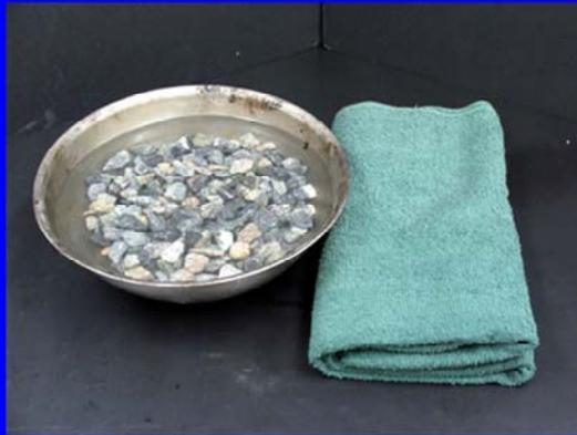
El valor de la Gravedad Específica se emplea en los cálculos volumétricos de una mezcla asfáltica y en la corrección de la combinación granulométrica de la mezcla de varios agregados en el caso de que las diferencias de la Gravedad Específica y otra sea mayor de 0.20
