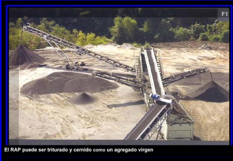
Este producto se ha convertido en un nuevo material de pavimentación. Esta mezcla asfáltica recuperada puede ser mezclada con agregado virgen y nuevo cemento asfáltico. Para utilizar este agregado se han creado "Plantas de Reciclaje" de los mismos, donde se encuentra una entrada para el agregado nuevo y otra para el reciclado
