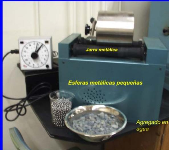
El agregado es sumergido en agua, luego se añaden a la jarra de acero inoxidable con 5.000 gramos de pequeñas esferas de acero. El recipiente es sellado y colocado en la base. El recipiente se rota a 100 rpm por dos horas. Luego se pasa el agregado por una serie de tamices. El material retenido en el tamiz #12 se coloca en otro recipiente y luego en un horno. El agregado se seca a una masa constante
