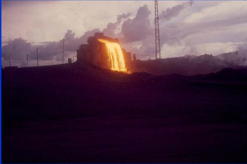
Aquí se observa como se vierte el material fundido que será utilizado como agregado
