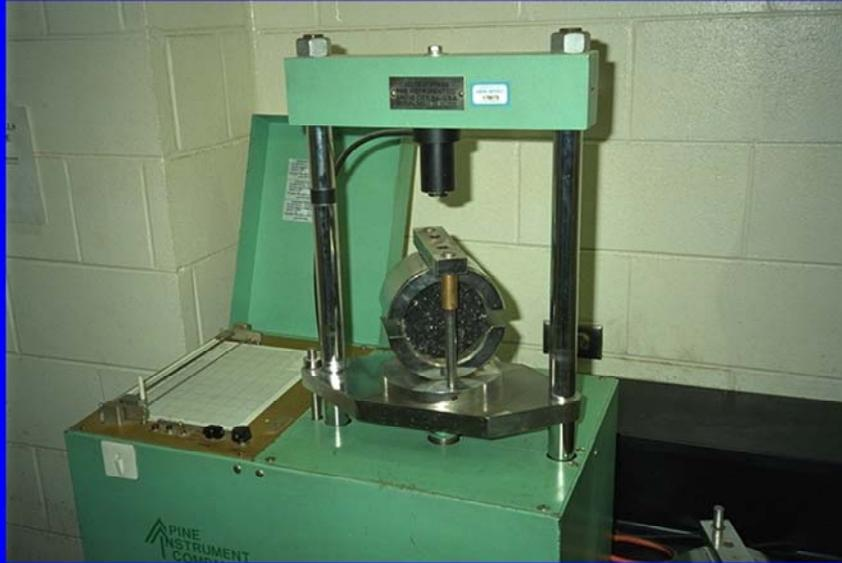
Este equipo logra registrar los valores obtenidos del ensayo automáticamente
