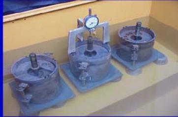
*a. La sobrecarga que se aplique mediante pesas de plomo, debe ser prácticamente igual a la correspondiente a las de las capas de pavimento a construirse sobre el material que se ensaya al CBR. La sobrecarga mínima a emplearse será de 4,54 kg (10 lbs), equivalente a la de un pavimento de concreto-cemento de aproximadamente 12,5 cm de espesor. Esta es la función primordial de las sobrecargas.*
