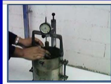
En la fotografía de la izquierda se ilustra la sobrecarga que se pondrá sobre la muestra durante la etapa de inmersión (que se hace para calcular nuevamente la humedad). En la fotografía de la derecha se muestra ya la sobrecarga colocada sobre la muestra. El periodo de inmersión es de cuatro días para garantizar que la muestra se sature completamente, lo que representa en la realidad la situación más desfavorable en la sub-rasante
