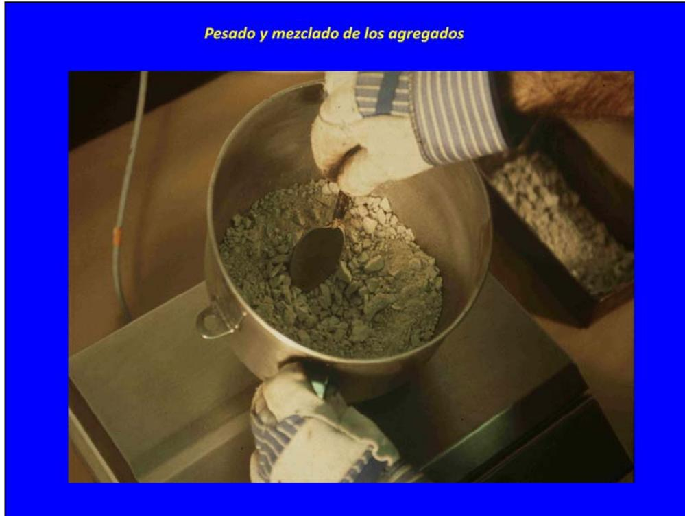
En esta fotografía se muestra el proceso de pesado de los agregados en el envase que servirá para la mezcla
