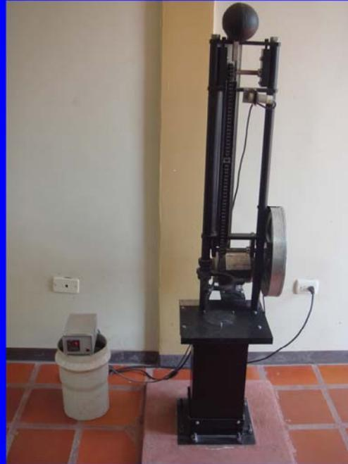
En la ASTM existían dudas sobre la compactadora mecánica. No se recomendaba su uso pues los pedestales pueden presentar distintas densidades, lo que compromete los resultados del ensayo
