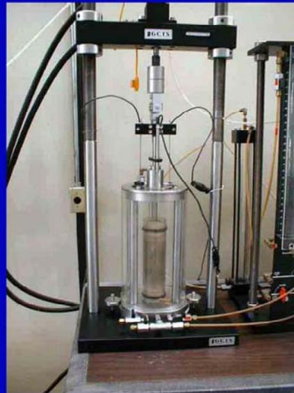
En la primera fotografía se observa un detalle de muestra con medidores de deformación instalados. En la segunda fotografía se muestra una celda de triaxial dinámico. Este ensayo no tiene mucha difusión en la actualidad en Venezuela, ya que no existen laboratorios que lo realicen, pero se han logrado desarrollar ecuaciones de correlación entre el valor del MR y de CBR
