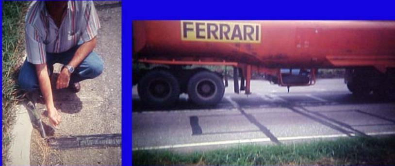
En este pequeño esquema se muestra el momento en el que un camión pasa sobre los sensores piezoeléctricos para que su carga sea registrada.
