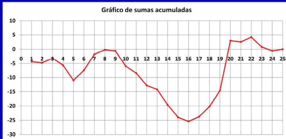
Mediante la hoja de cálculo Excel, se grafican los valores de progresiva y Si, con el resultado que se observa en la lámina. En este gráfico, en donde hay un "cambio de pendiente" habrá una variación de valores promedio de CBR, y el Ingeniero deberá analizar el gráfico de acuerdo a su criterio, a fin de definir "Unidades Homogéneas" que no resulten con longitudes que, por ser demasiado pequeñas, sean imprácticas de seguir en obra.
