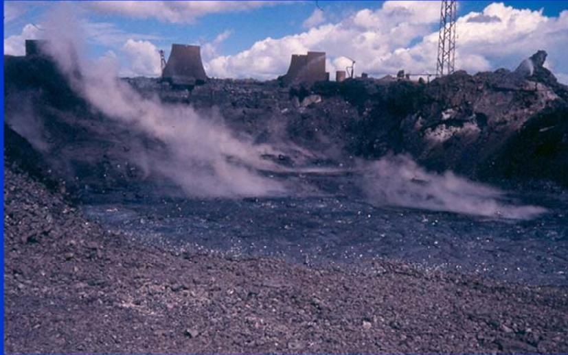
En esta fotografía se ilustra el proceso de enfriado de la escoria de la acería procesada
