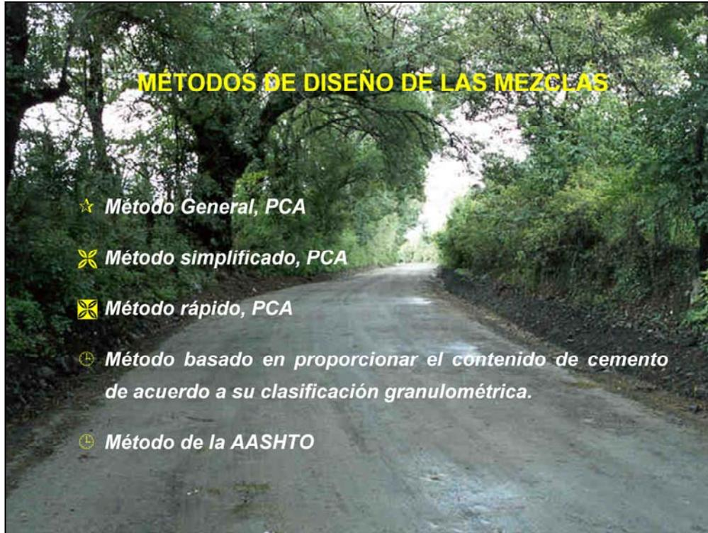
En esta lámina se enumeran los métodos de diseño de las mezclas de Suelocemento, tanto por el PCA (Portland Cement Association) y AASHTO. A continuación se hará una descripción de cada método. Para la realización de una mezcla de Suelocemento se necesitan cantidades correctas de cemento y agua, así como la densidad y resistencia requerida, que las darán estos métodos
