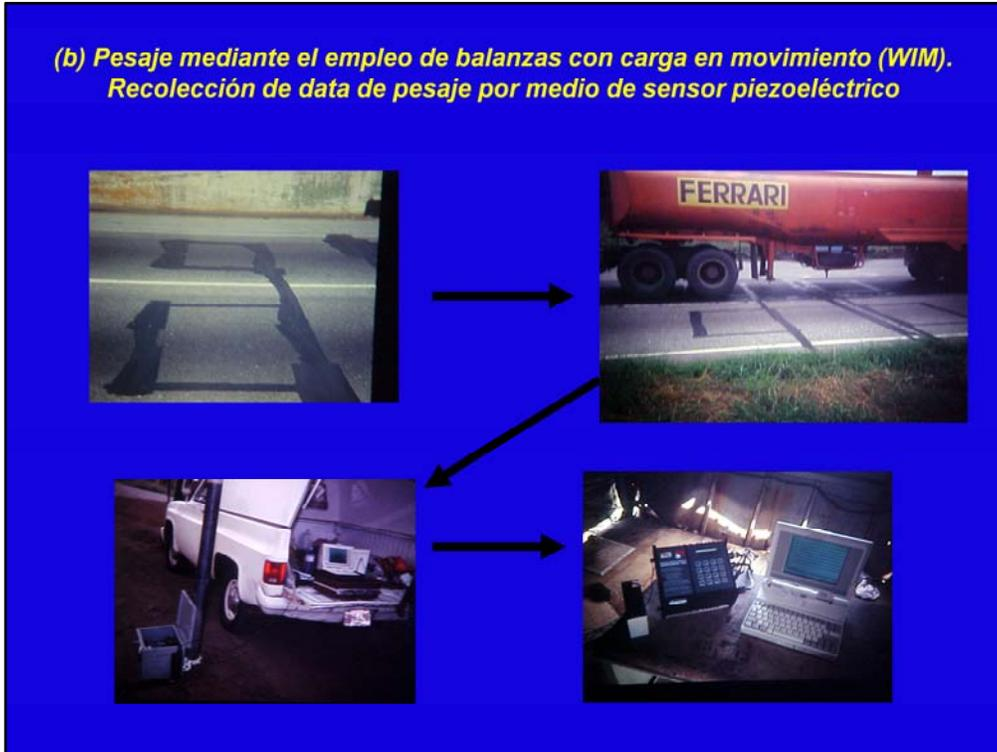
El esquema muestra el procedimiento de recolección de la data de pesaje por medio de un sensor piezoeléctrico. En la primera fotografía se observa el sensor piezoeléctrico ya colocado y debidamente sellado. En la segunda fotografía se observa el método en funcionamiento, es decir, un camión pasando por encima de la zona, de modo que el sensor transmite la información al equipo que registra los pesos y por último se pasa la información a un computador
