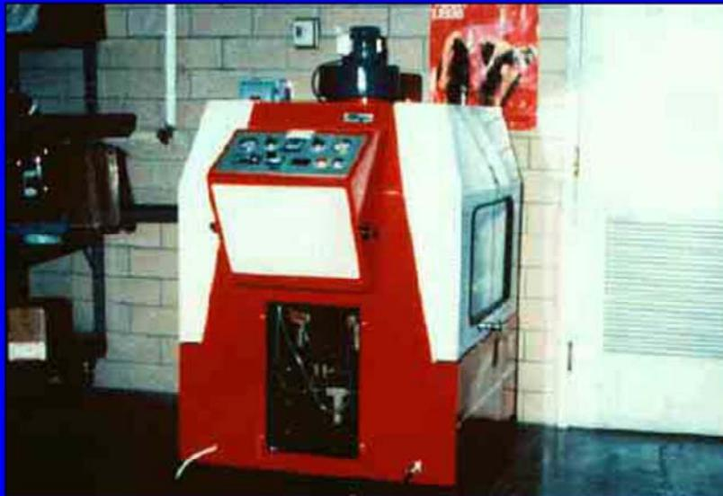
En esta fotografía se observa el equipo francés de ensayo para ahuellamiento (FRT). El ensayo se realiza normalmente y aplicando una fuerza de 1124 libras (o 5000 N) transmitida a través de una rueda neumática con una presión de 87 psi (600 kPa)
