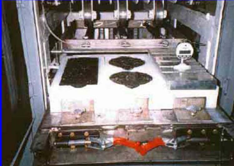
Aquí podemos observar una vista parcial del Analizador de Pavimentos de Asfalto. Se divisan claramente las muestras de la mezcla y las ruedas de aluminio.
