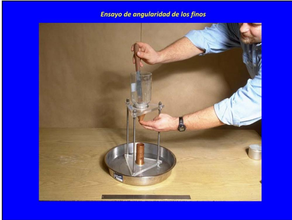
En esta fotografía se observa como se nivela y extraen los vacíos antes de dejar caer la muestra en el cilindro.
