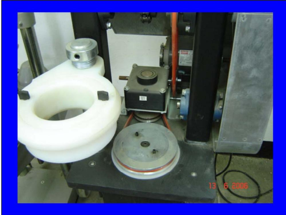
En esta fotografía se muestra en detalle un nuevo método en el que la briqueta se encuentra mas protegida (nótese el aro blanco), por ende se realiza el ensayo con mayor seguridad
