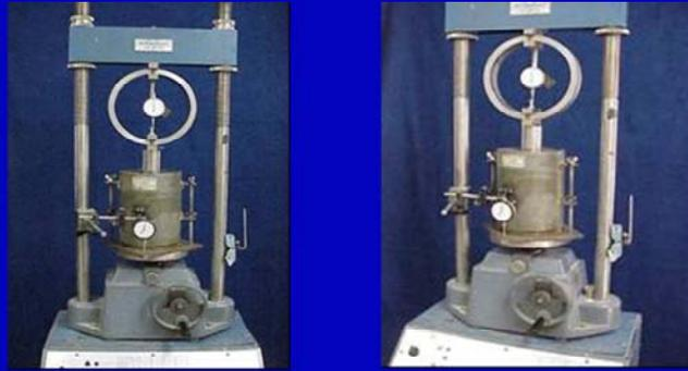
5. Las cargas registradas en el paso anterior se dividen entre 3,0 (área del pistón normalizado en pulgadas cuadradas), para obtener el "esfuerzo unitario" para cada profundidad de penetración. Durante esta etapa del ensayo se mantienen sobre cada muestra, como mínimo las sobrecargas de 10 libras.
