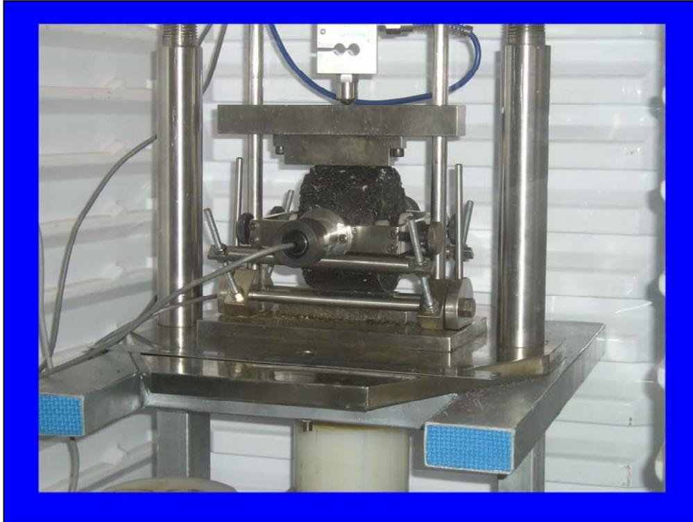
En esta fotografía se muestra tanto la “Mordaza Lottman” como el tipo de fractura que se produce en un briqueta cuando se somete a este ensayo de carga por tensión directa
