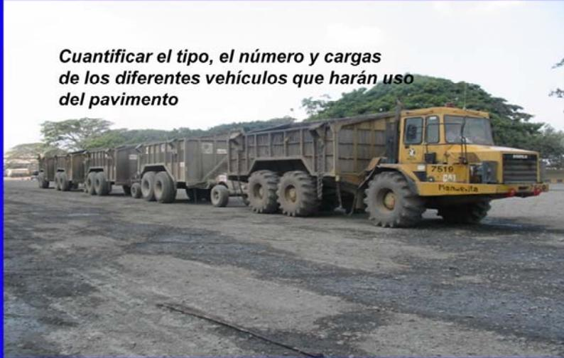
Para el dimensionamiento de un pavimento es necesario determinar los efectos de las cargas que los vehículos causaran sobre el pavimento, por lo cual se debe conocer el número y tipo de vehículos que circularán por una vía, así como la intensidad de la carga y la configuración del eje que la aplica.
