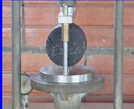
El Método Marshall para el diseño de mezclas asfálticas en caliente
