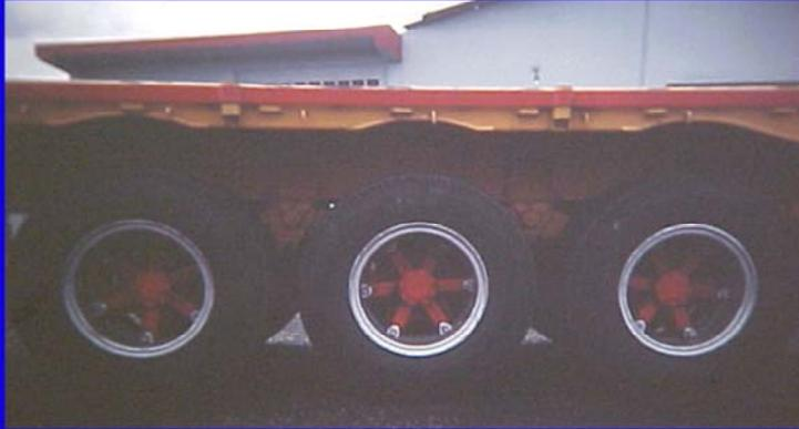
En la fotografía se muestra el detalle de un eje tripe, que es el conjunto de tres ejes sencillos
