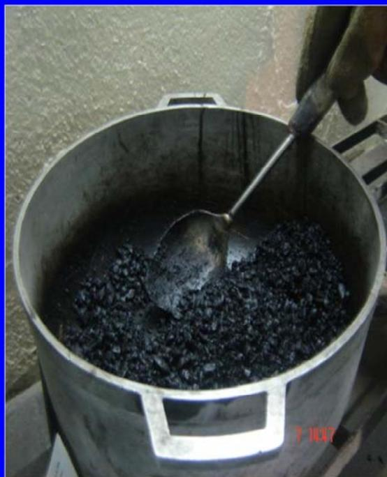
En esta fotografía se ilustra el mezclado manual de la mezcla a ser empleada para la elaboración de las briquetas para el Ensayo Marshall. El mezclado mecánico es más efectivo que el manual por la poca intervención del factor humano
