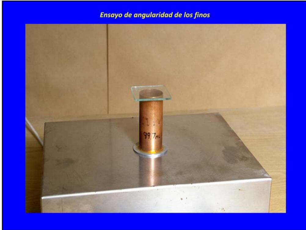
En esta fotografía se muestra el cilindro, en este caso de 99.7 ml en el que se realiza el ensayo de angularidad de los finos.
