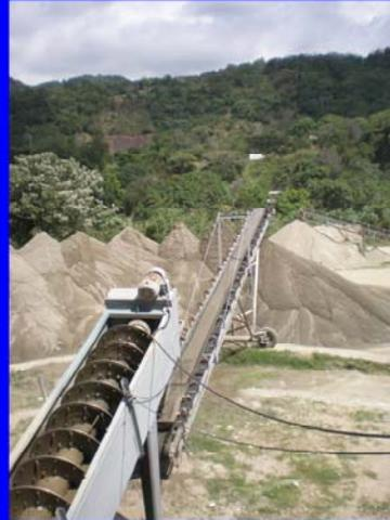
En las fotografías mostradas se observa el agregado siendo lavado para satisfacer el valor exigido de Equivalente de Arena. En la fotografía de la derecha se muestran las pilas del material ya lavado siendo transportado del tornillo sin fin, luego hacia la correa transportadora y luego a las pilas de agregado
