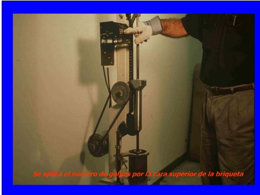
En esta fotografía se ilustra el proceso de compactado mecánico de las briquetas.
