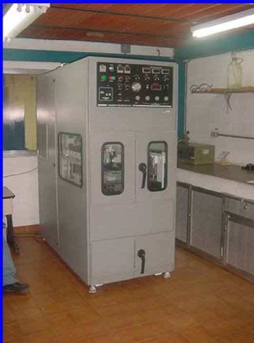
En esta fotografía se muestra otra vista del equipo utilizado para la medición de ahuellamiento llamada "Analizador de Pavimentos de Asfalto (APA)"
