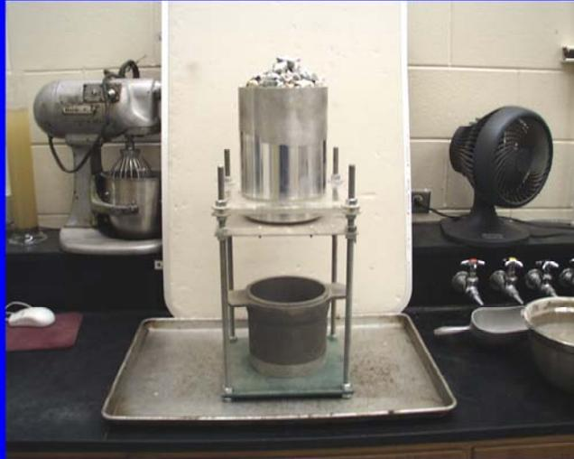
En esta fotografía se muestra el equipo necesario para la determinación de vacíos en agregado grueso. Esta es una manera de utilizar las diferencias en los vacíos debido a la forma y textura del agregado para estimar la angularidad
