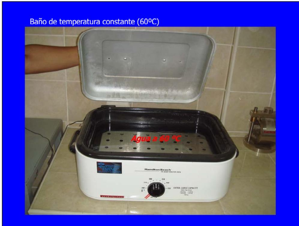
Las briquetas se sumergen en un baño de temperatura constante a 60 °C para simular las temperaturas altas a las que puede llegar un pavimento
