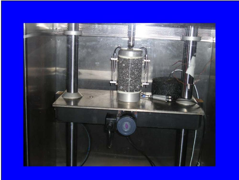
Esta fotografía muestra el equipo empleado para el ensayo del módulo dinámico complejo, que se determina mediante la aplicación de cargas sinusoidales verticales a briquetas cilíndricas mientras se mide la deformación. Este ensayo ha sido normalizado por la ASTM bajo el número D3497, y en él se requiere la relación altura/diámetro de la muestra sea al menos 2:1, con el fin de minimizar los efectos de la fricción en las caras superior e inferior de la muestra.
