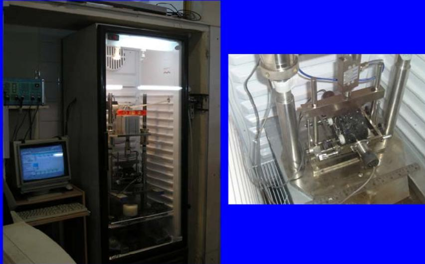
La muestra se somete a calor y simulando condiciones de trafico
