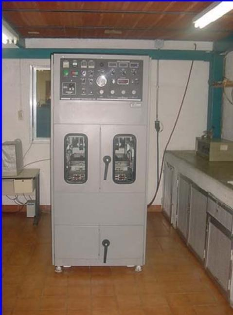
Este ensayo se realiza normalmente con ocho mil (8000) pasadas de una rueda de aluminio con una carga de 100 libras que se apoya sobre una manguera lineal neumática resultando un esfuerzo de presión de 100 psi (609 kPa)
