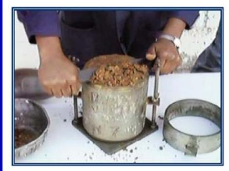
En la fotografía de la izquierda se muestra la muestra siendo compactada con el martillo de 10 libras de peso y se acota que éste debe tener una caída de 18 pulgadas. A la derecha se observa una de las briquetas siendo enrasada luego de pasar por el proceso de compactación. Se recuerda que se deben hacer tres briquetas y compactarlas con 56, 25 y 12 golpes por capa respectivamente.
