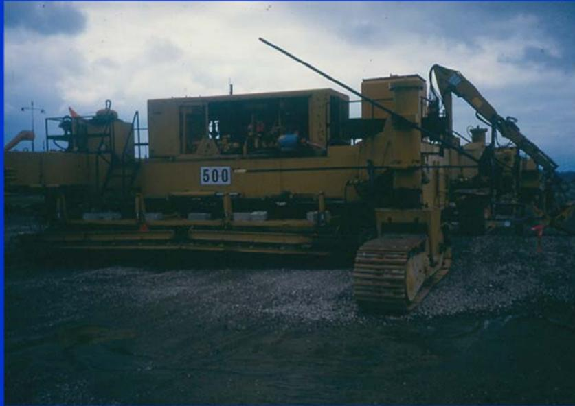
En esta fotografía podemos observar un Spreader especialmente diseñado para extender la capa granular a todo lo ancho de la calzada.
