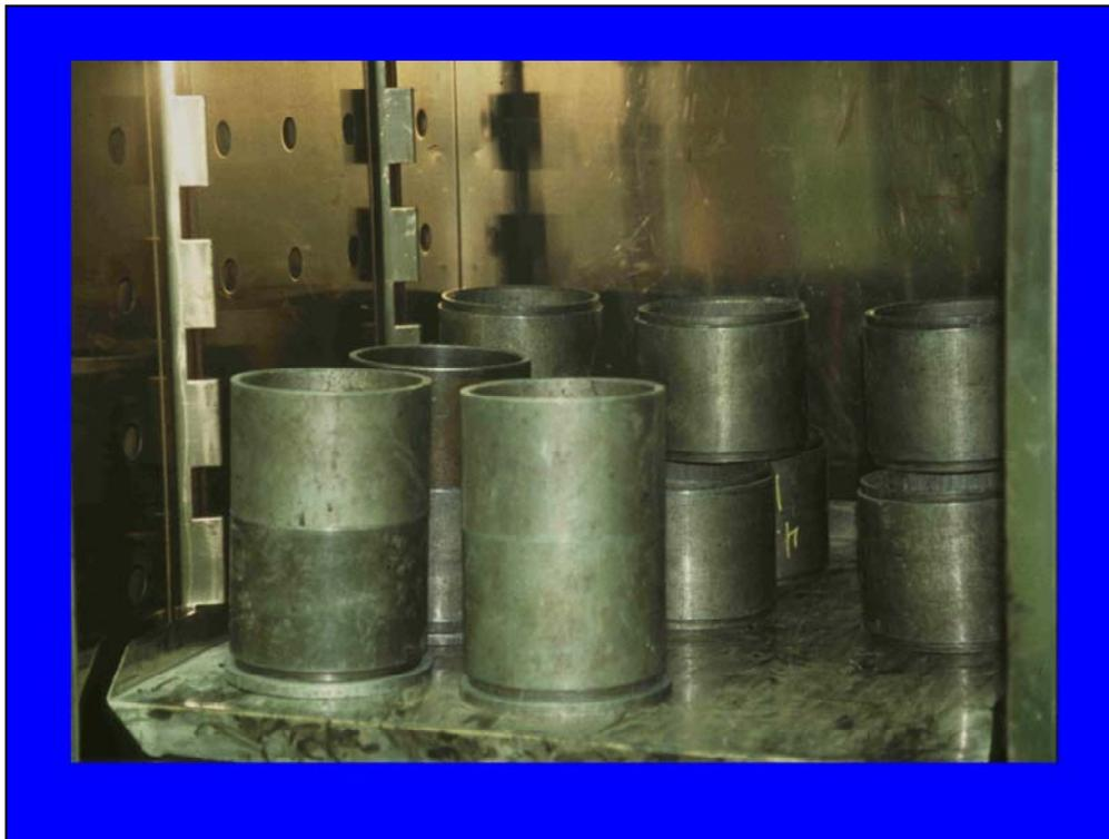
Una vez preparadas, las briquetas se introducen en un horno para ser calentadas a la misma temperatura del ligante para cumplir con la temperatura de mezcla establecida por la curva viscosidad-temperatura. Si las temperaturas de los materiales son distintas no se cumpliría con la temperatura óptima de mezclado y podrían presentarse problemas en la absorción y cubrimiento apropiado del ligante de todas las partículas de la mezcla
