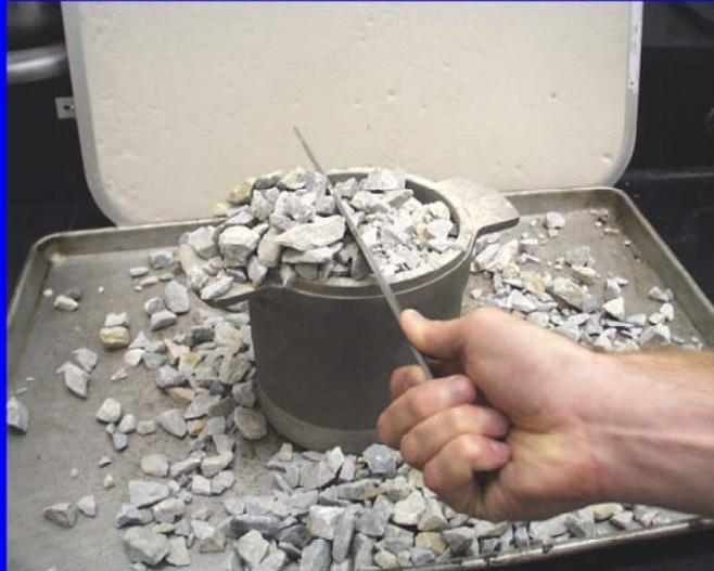
El segundo paso es nivelar el tope del recipiente y luego pesarlo para determinar la masa de agregado en el volumen conocido (se resta la tara del recipiente) el volumen de vacíos luego es computado de una relación estándar masa/volumen
