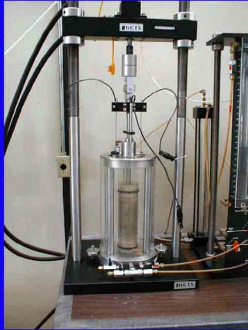
En esta fotografía se puede observar el equipo necesario para realizar el Ensayo Triaxial
