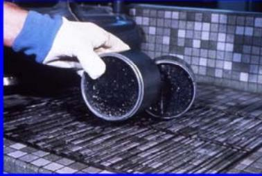
Se dejan enfriar las briquetas (pastillas) hasta que puedan ser extraídas del molde sin deformarse
