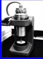
*Ensayo de reómetro dinámico de corte:*
