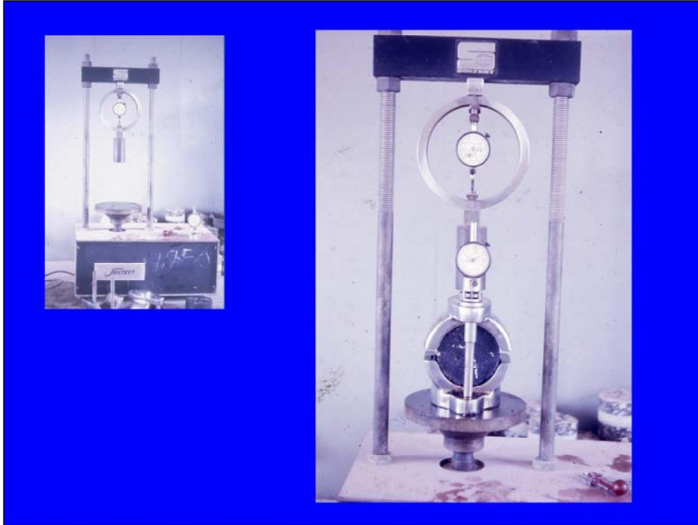
En las fotografías se muestra un Fluxómetro que indica valor de la estabilidad de las briquetas
