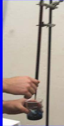
El próximo paso es la preparación de 200 ml de solución de azul de metileno. Esto se hace disolviendo un gramo de azul de metileno en suficiente agua destilada como para producir este volumen
