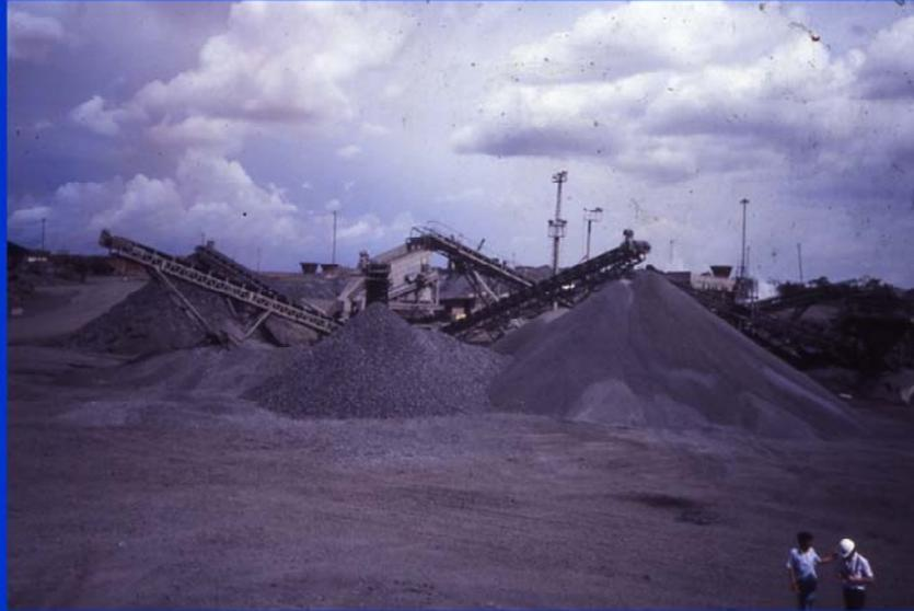
Aquí podemos observar el procesamiento de los agregados siderúrgicos para que puedan ser efectivamente utilizados en la construcción de la estructura de pavimento
