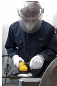
Figura 8: Trabajador realizando un procedimiento de esmerilado. Fuente: Gerencia de Proyectos de Grupo Vemacero C.A
