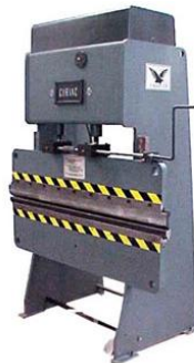
Figura 7: Dobladora mecánica para lamina de cortina “Curvac” Eagle 15 toneladas. Fuente: http://www.ferremaq.com/ferremayoreo_detalle_pb2.asp?Maquina=MOD.+EAGLE+15+TONS
