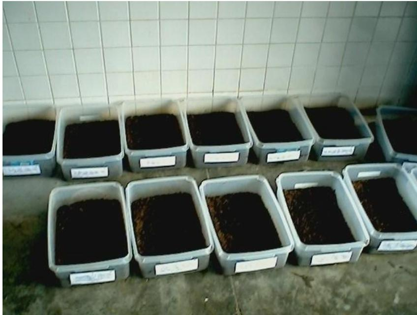
**Figura 2. Aspecto de los composteros preparados con la mezcla suelo, hojarasca, fertilizante y crudo, según el caso, con los diferentes tratamientos.**
