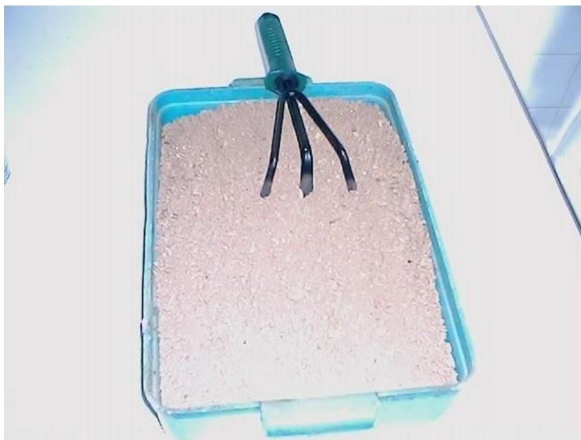
**Figura 1. Aspecto del suelo tamizado antes de mezclarlo con la hojarasca y el crudo.**
