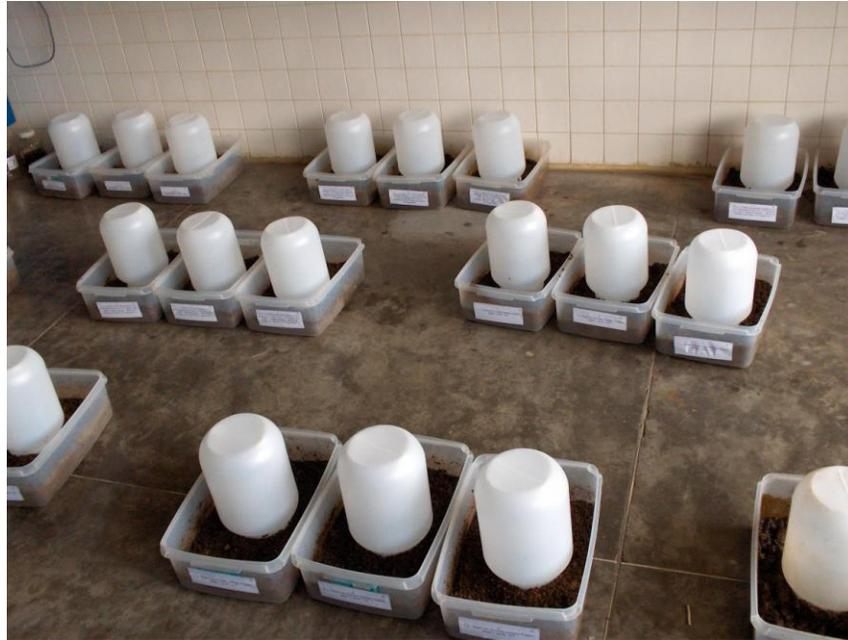
**Figura 6. Cámaras invertidas (respirómetros) para la retención de CO<sub>2</sub>**
