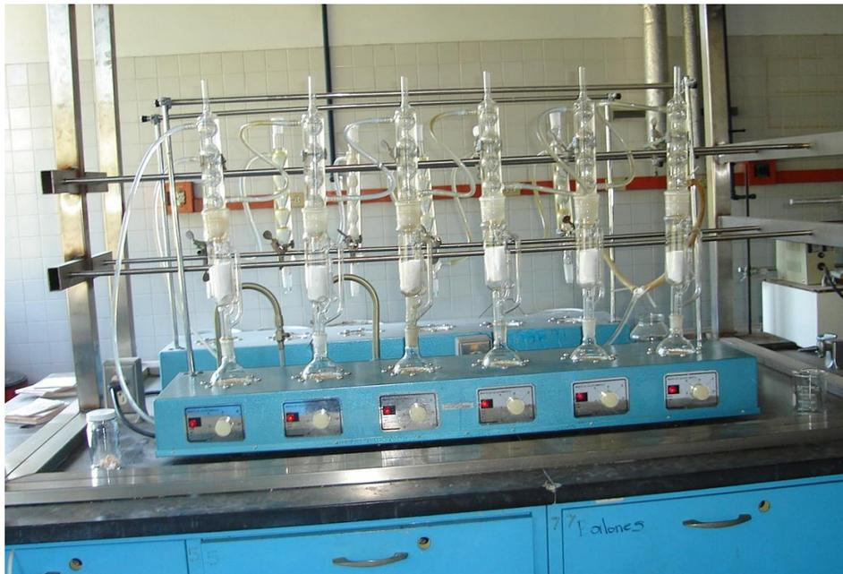
**Figura 3. Equipo Soxhlet para extracción continua de crudo.**
