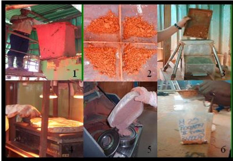
Figura 16 Procesamiento físico de muestras de Producción:
