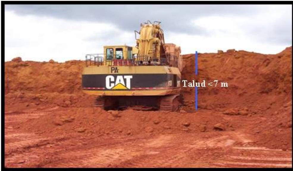
Figura 14 Corte con pala en talud menor de 7 metros
