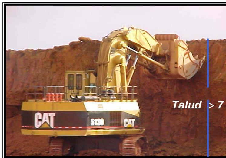
Figura 13 Corte con pala en talud mayor a 7 metros
