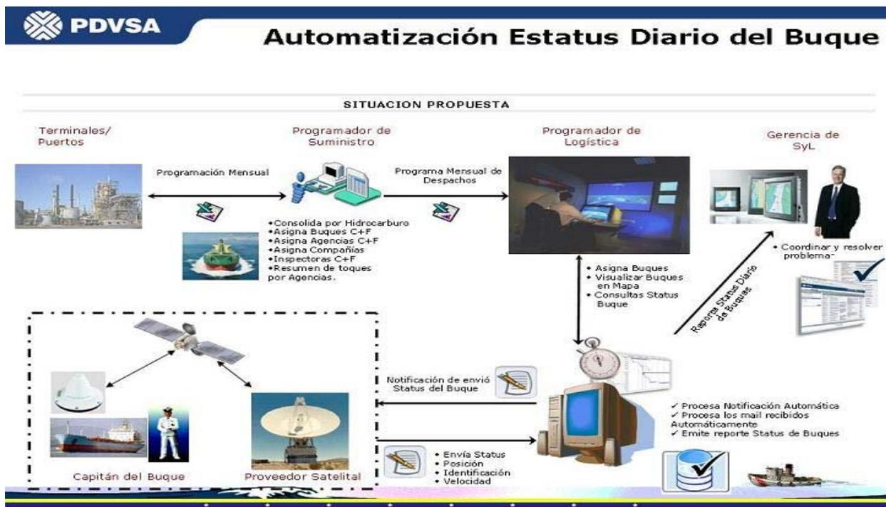
**Figura # 45: Arquitectura del Software Propuesto para automatizar el Reporte de Status del Buque. Fuente: El Autor**
