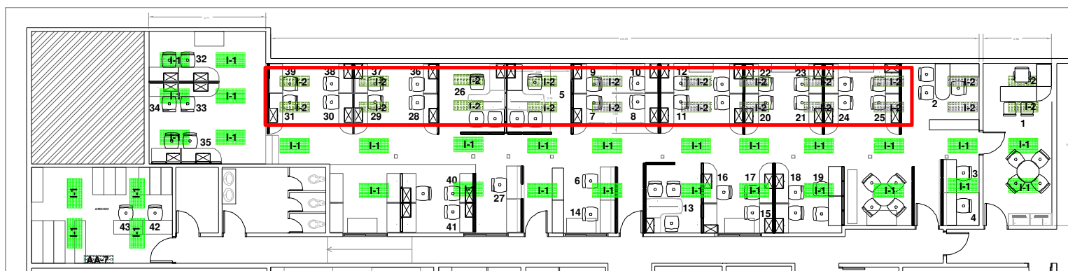
Figura 20. Planta, distribución de la iluminaria. Fuente: Diseño Propio
