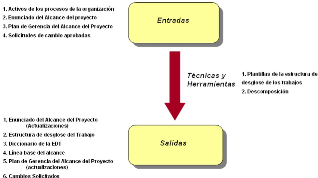
2.15. Creación de la EDT: Entradas, Herramientas y Técnicas, y Salidas. Fuente: PMBOK
