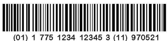
**Figura 11.** Estructura de la Codificación EAN/UCC 128
