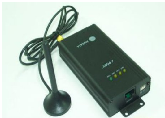
Figura 17 Módulo EMII-800 para conexión a la red CDMA. Fuente: www.anydata.net
