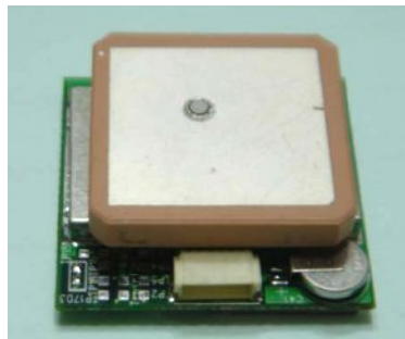
Figura 16 Módulo GPS EM-406 de GlobalSat. Fuente: www.globalsat.com
