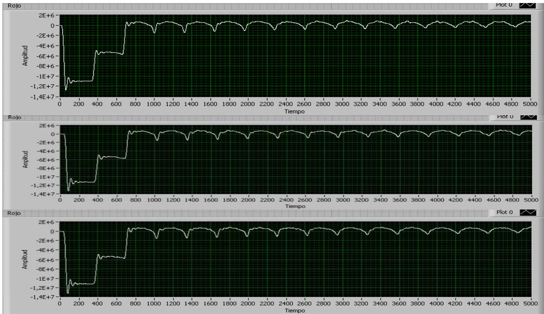
**Figura V.53.-Comparación de Señales R. Señal entrante, Salida AM y Salida DSB**
