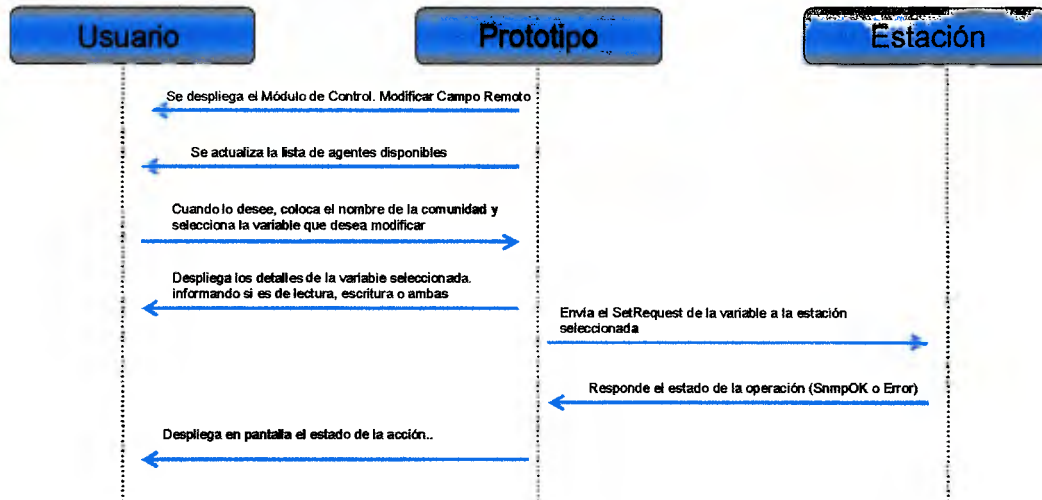
Figura 9. Pantalla Estándar Módulo de Control. Modificar Campo Remoto Fuente: Elaboración Propia
