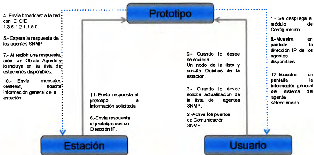
Figura 2. Diagrama de Colaboración Fase 1 del Módulo de Sesión y Configuración
