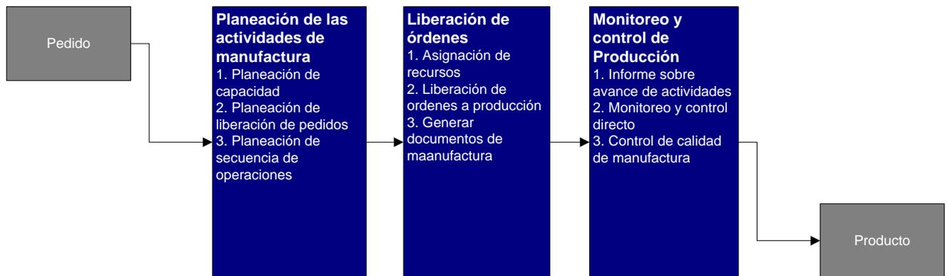
**Figura 13.** Procedimiento de planeación y control de producción de la fábrica.
