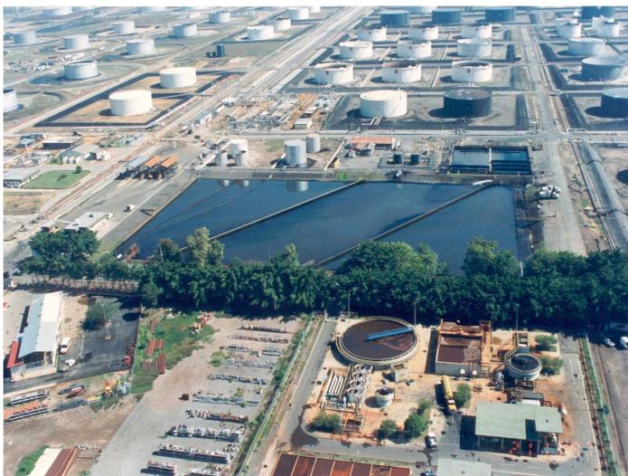
filtrado, para luego por último ir a la descarga submarina, hacia la Bahía de Pozuelos, de la ciudad de Puerto La Cruz. Del agua decantada quedan los lodos petrolizados que van al recuperador de lodos y se almacenan conjuntamente con los lodos de fondo. Estos lodos petrolizados son desechos peligrosos.
