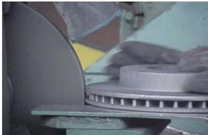
Colada la pieza, se procede a extraer del moldeo, en un proceso de desmoldeo. Posteriormente se esmerila la pieza en todas aquellas partes exteriores donde quede exceso de metal y que no forme parte de la geometría de la pieza a elaborar.
