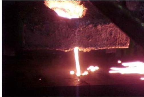
Una vez realizado el molde de la pieza y puesto el macho en la máquina de moldeo, se procede al proceso de colada. (TITOV, SREPANOV, 1981, P.310)
