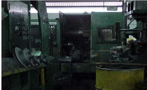
Hecha la pieza se lleva a la zona de mecanizado en donde se le dará las características superficiales necesarias a la pieza, de trabaja la pieza en una máquina que va quitando la superficie rugosa del disco recientemente fundido hasta convertirlo en uno con superficie lisa; característica requerida para ser usado en el automóvil.
