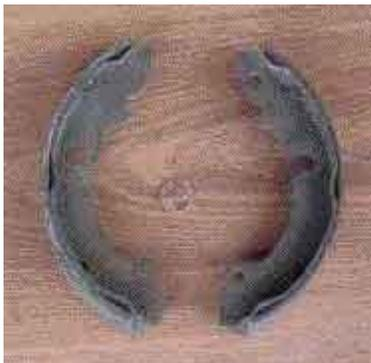
El desgaste de las zapatas se pueden advertir en el recorrido del freno de mano o emergencia. Cuando sienta que el recorrido del freno de mano esta bastante largo, es que llego el momento de cambiar frenos de atrás.
