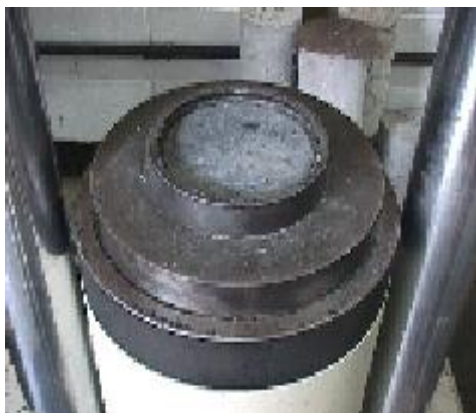
figura 8. Tapa retenedora colocada en el cabezal inferior
