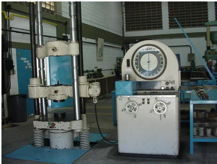
FIGURA 1. MÁQUINA BALDWIN TATE EMERY DE 100 TONELADAS
