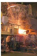
La fabricación de acero en SIDOR se cumple mediante procesos de Reducción Directa y Hornos Eléctricos de Arco, complementados con Metalurgia Secundaria en los hornos de cuchara que garantizan la calidad interna del producto.
