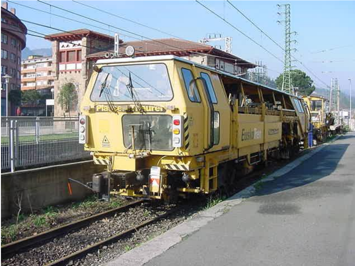
Fig. Nº 07.- Máquina Split Head 08-16 (Fuente Plasser&Theurer)
