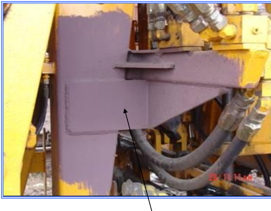
Figura N° 16, Soportes instalados para reforzar viga que soporta las mangueras del grupo de bateo.
